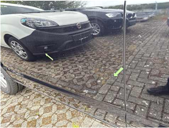
Türe hinten rechts (Kratzer, Delle)
