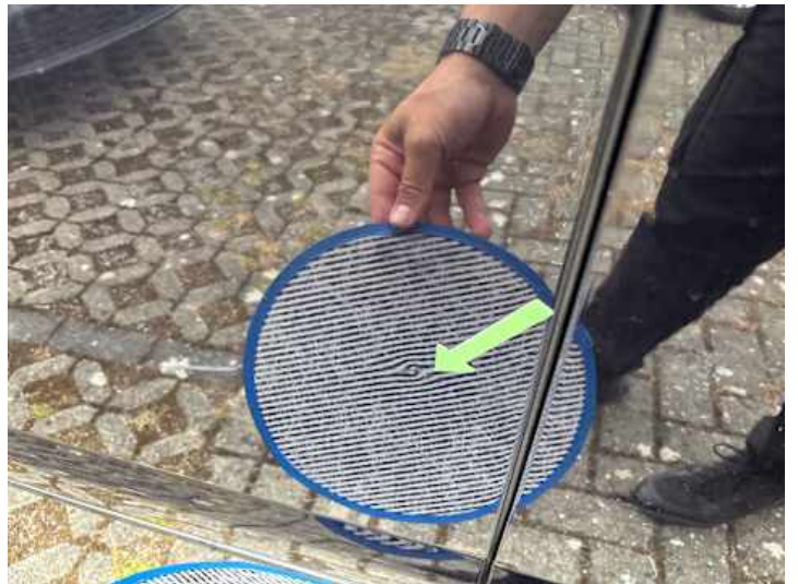
Türe hinten rechts (Kratzer, Delle)
