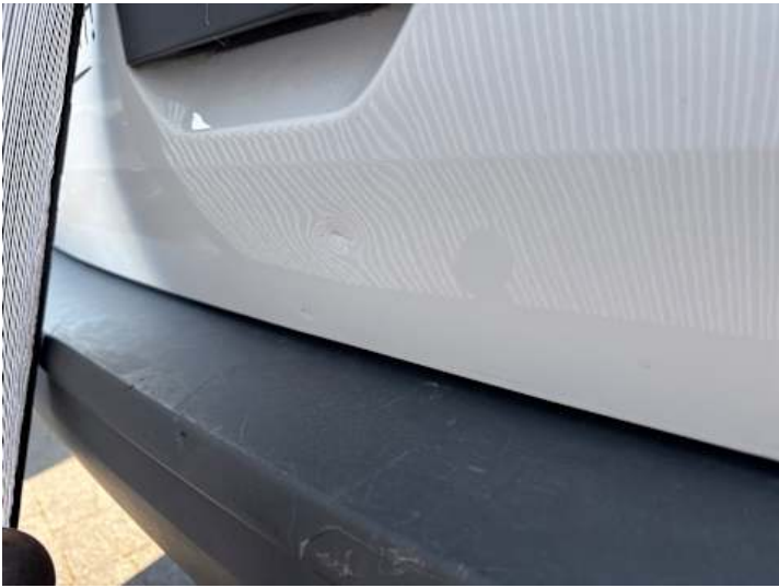
Heckklappe (Delle, Kratzer)
