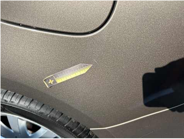
Seitenteil hinten links (Kratzer)
