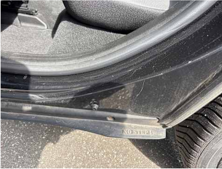
Schweller links (Kratzer)
