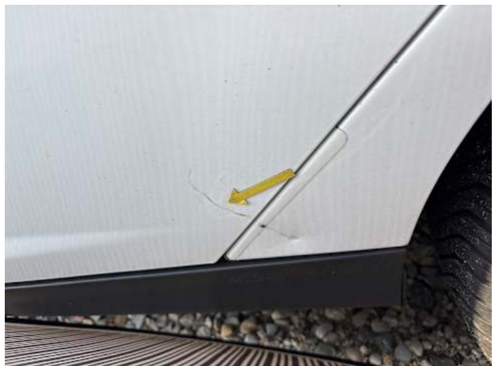
Türe hinten links (Kratzer, Delle)
