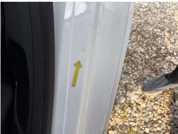
Türe hinten links (Kratzer, Delle)
