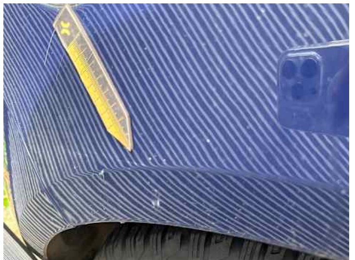
Seitenteil hinten rechts (Lackschaden, Delle)
