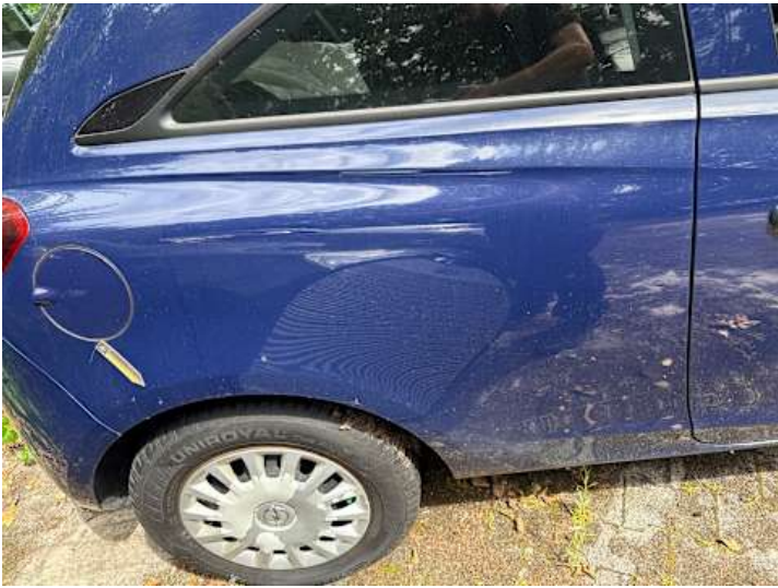
Seitenteil hinten rechts (Lackschaden, Delle)
