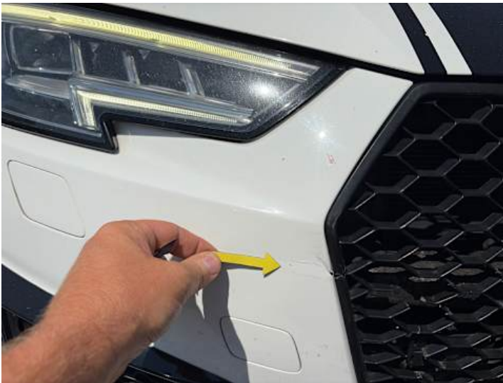
Stoßstange vorne (Riss/Bruch)
