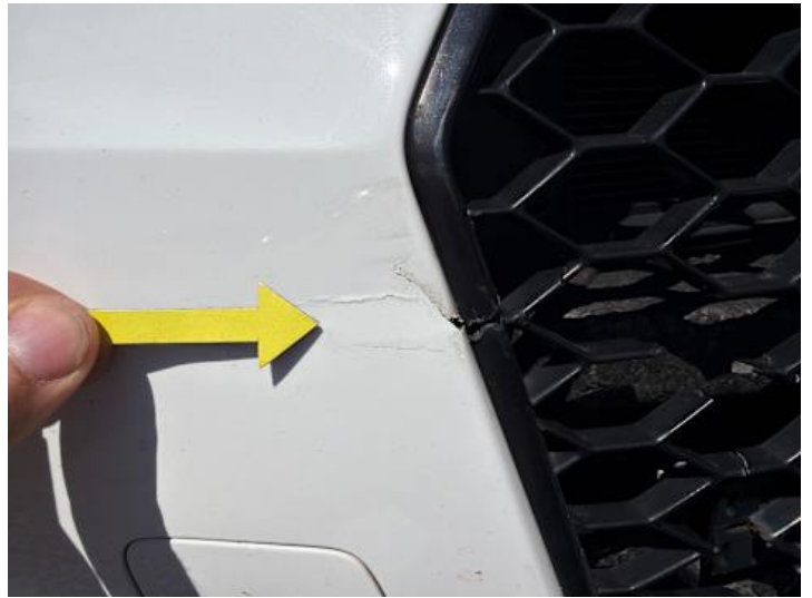
Stoßstange vorne (Riss/Bruch)
