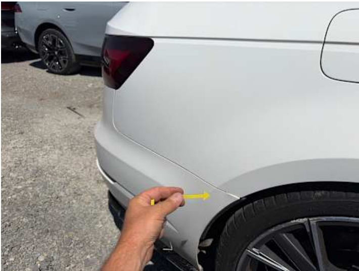
Stoßstange hinten (Kratzer, Spaltmaße ungenau)
