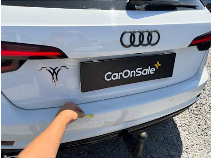
Stoßstange hinten (Riss/Bruch)
