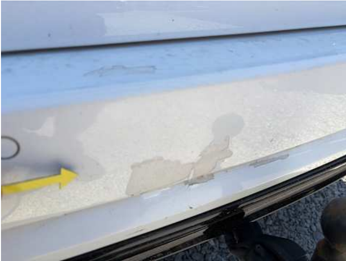
Stoßstange hinten (Riss/Bruch)
