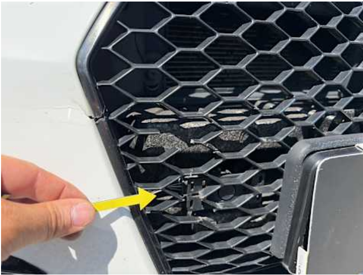
Stoßstange vorne (Riss/Bruch)
