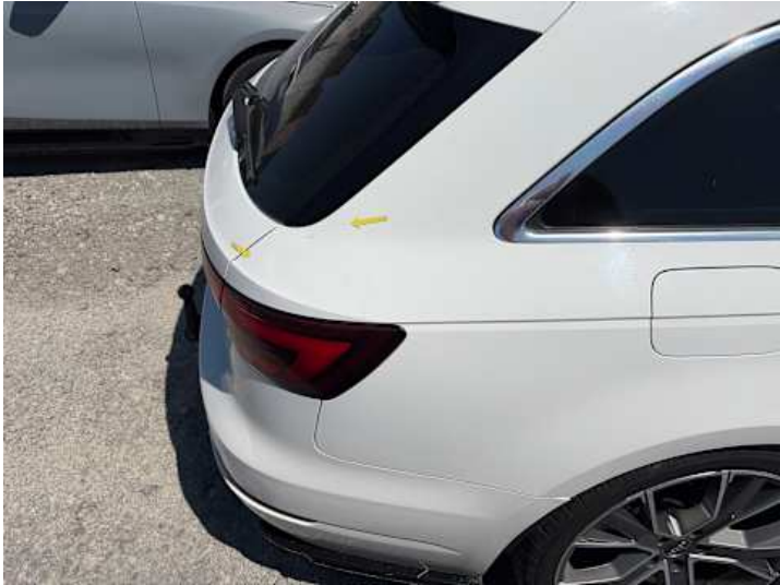
Seitenteil hinten rechts (Kratzer, Delle)
