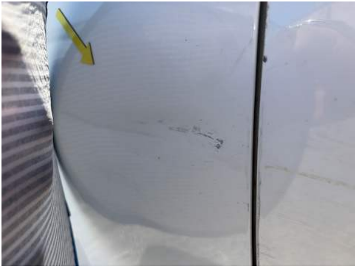
Kotflügel vorne links (Kratzer, Verformung)
