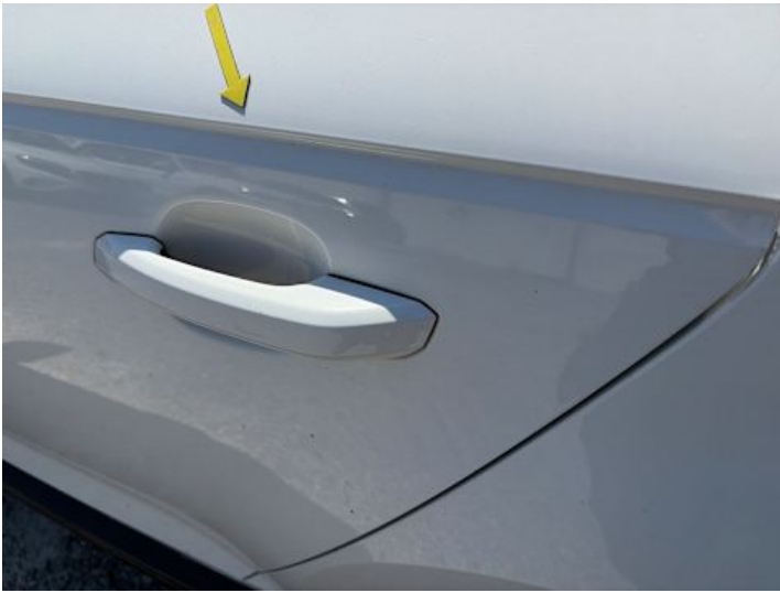
Türe hinten links (Kratzer, Delle)
