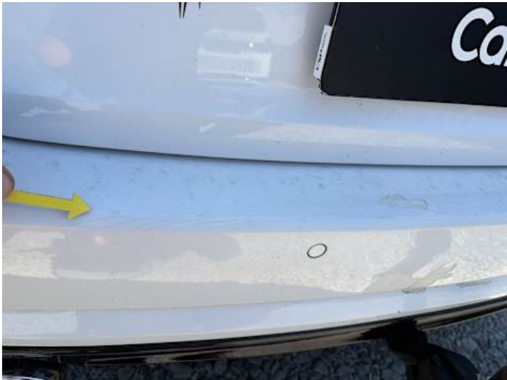
Stoßstange hinten (Riss/Bruch)
