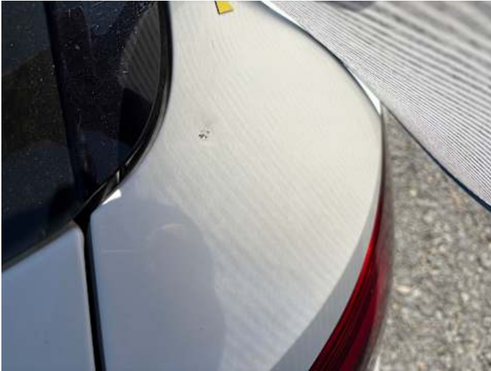
Seitenteil hinten rechts (Kratzer, Delle)
