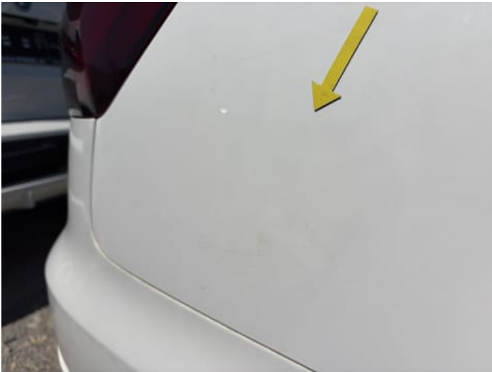
Seitenteil hinten rechts (Kratzer, Delle)
