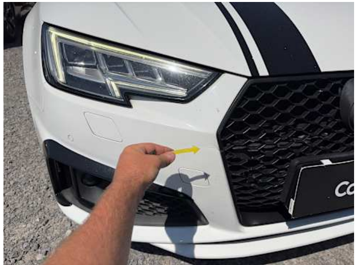
Stoßstange vorne (Riss/Bruch)
