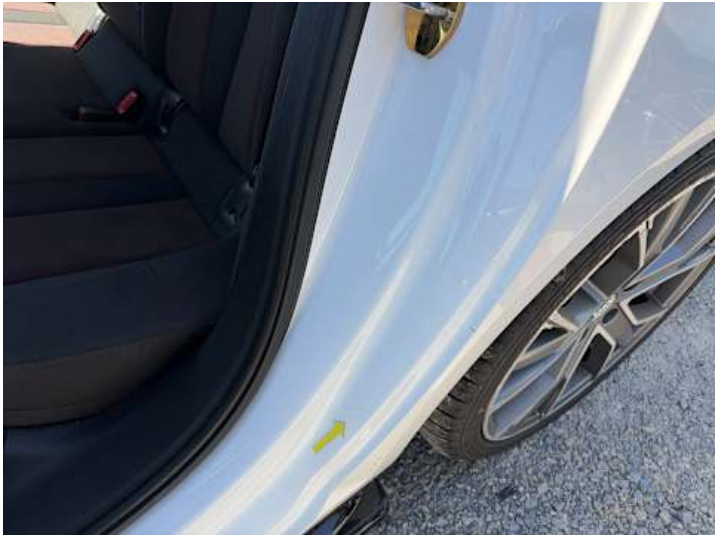
Türe hinten links (Kratzer, Delle)
