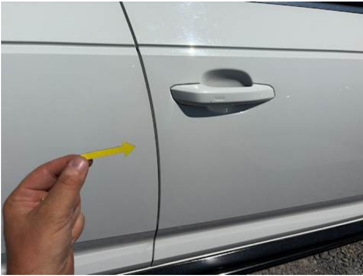
Beifahrertür (Verformung, Kratzer)
