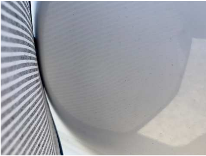
Fahrtür (Kratzer, Delle, Verformung)
