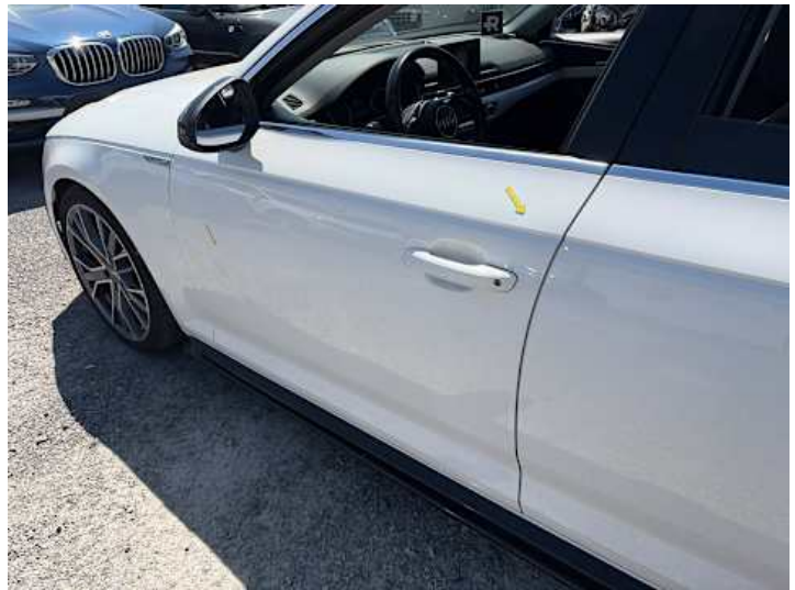
Fahrtür (Kratzer, Delle, Verformung)
