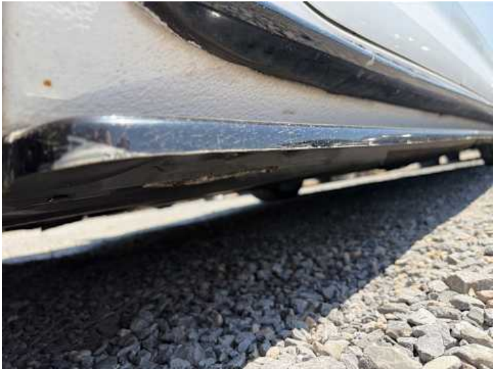
Schweller rechts (Kratzer)
