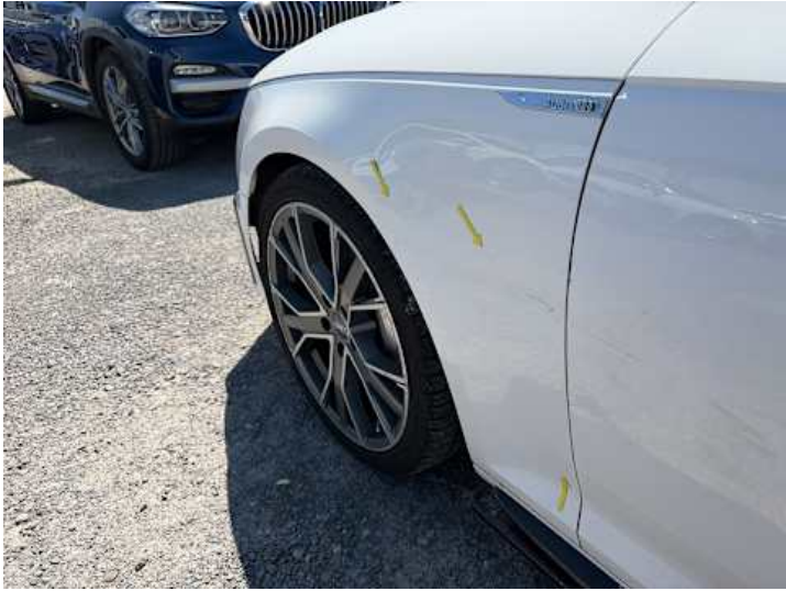
Kotflügel vorne links (Kratzer, Verformung)
