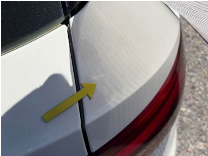
Seitenteil hinten rechts (Kratzer, Delle)
