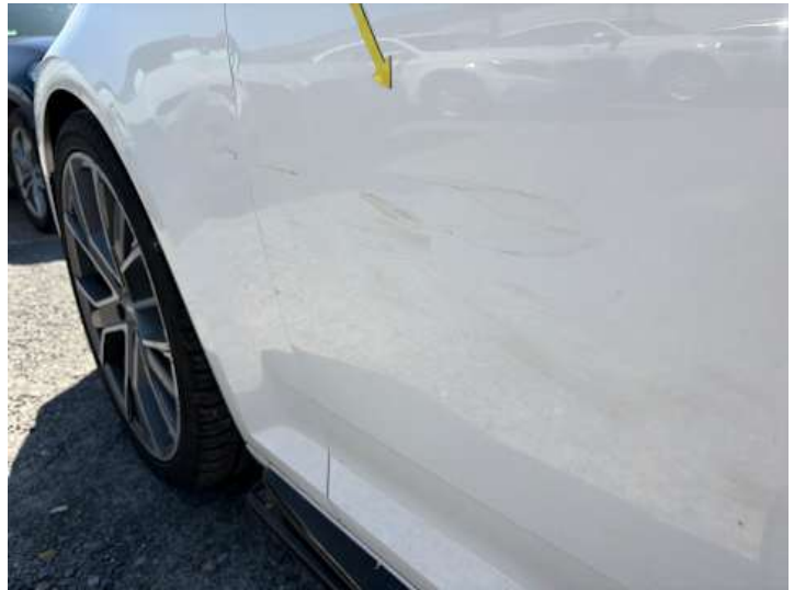
Fahrtür (Kratzer, Delle, Verformung)
