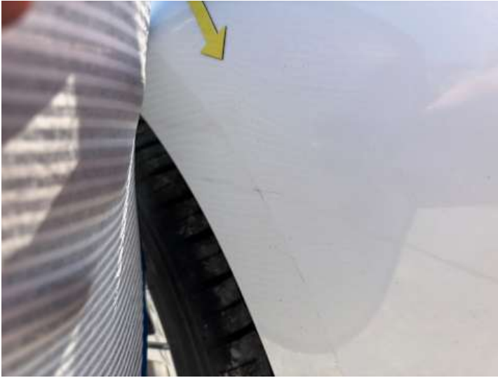
Kotflügel vorne links (Kratzer, Verformung)
