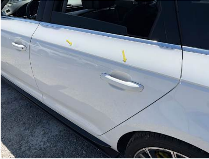
Türe hinten links (Kratzer, Delle)
