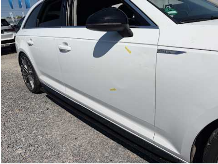
Beifahrertür (Verformung, Kratzer)
