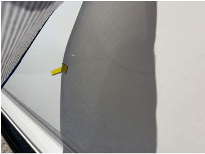
Beifahrertür (Verformung, Kratzer)
