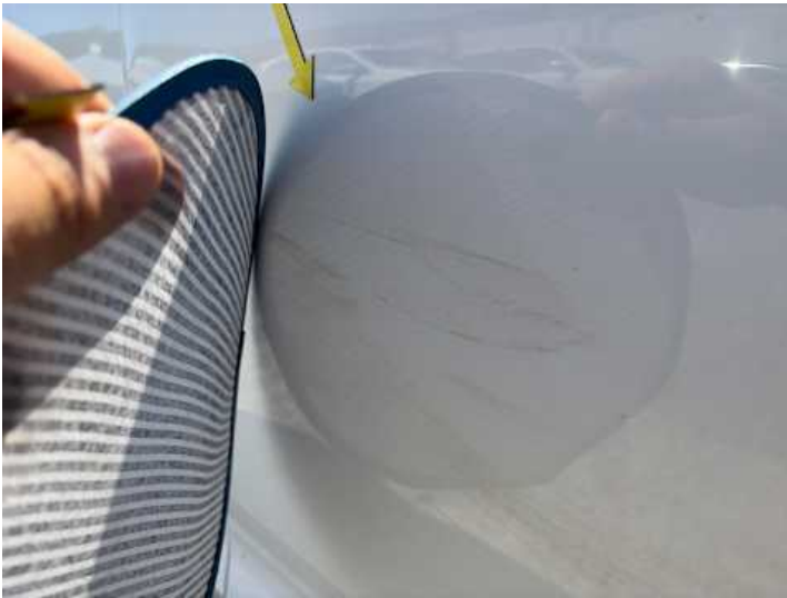
Fahrtür (Kratzer, Delle, Verformung)
