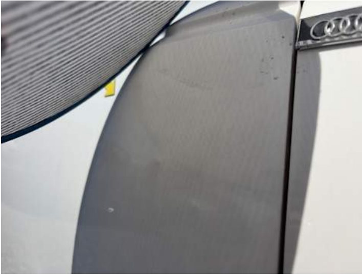
Beifahrertür (Verformung, Kratzer)
