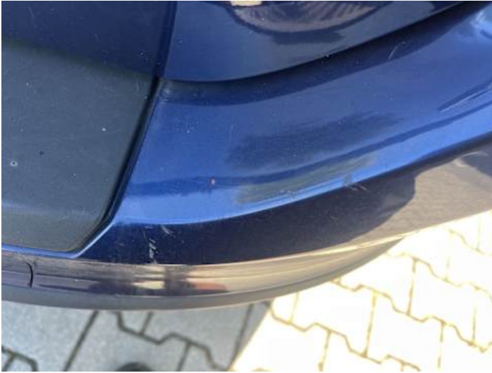
Stoßstange hinten (Kratzer, Lackschaden)
