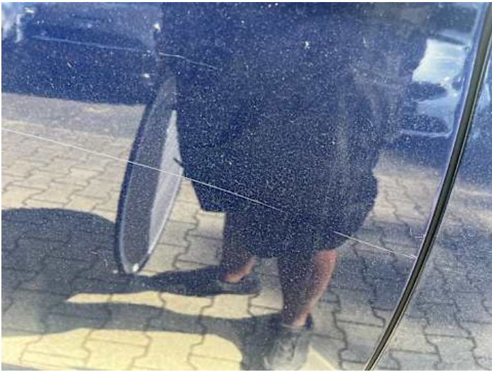
Türe hinten rechts (Kratzer, Lackschaden)
