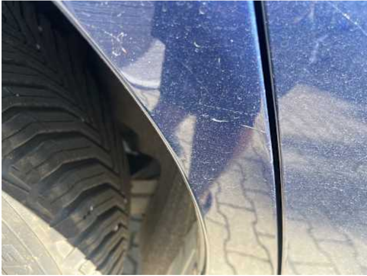
Seitenteil hinten rechts (Kratzer, Lackschaden)
