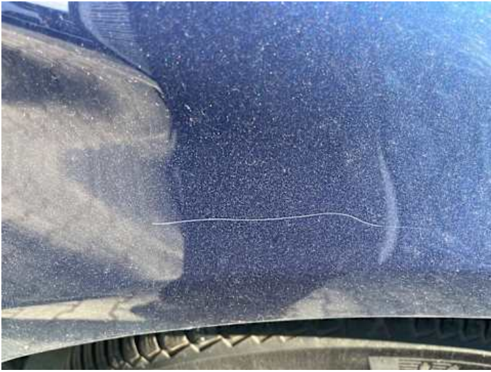
Kotflügel vorne rechts (Kratzer, Lackschaden)
