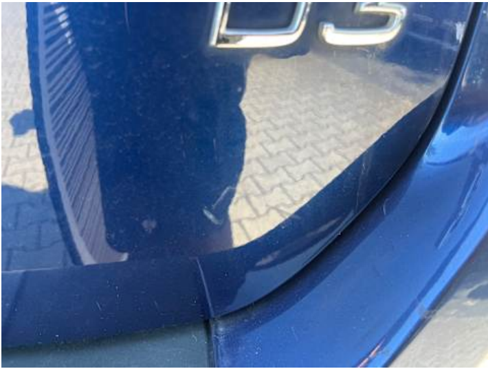
Heckklappe (Kratzer, Lackschaden)
