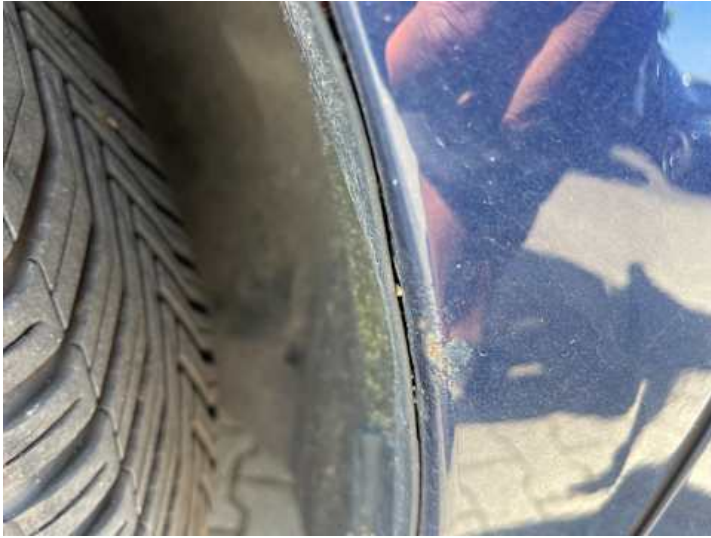
Kotflügel vorne links (Lackschaden, Rost)
