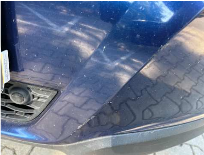
Stoßstange vorne (Kratzer, Lackschaden)
