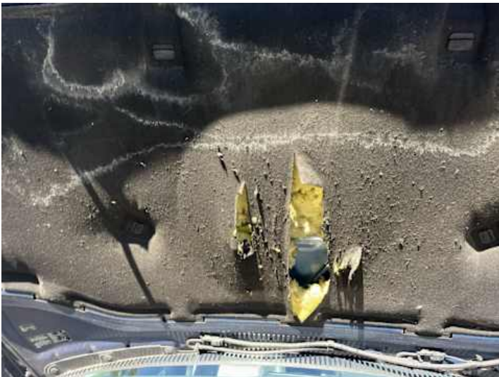
Motorhaube (Anderer Schaden): Dämmmatte beschädigt
