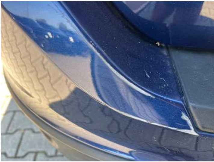
Stoßstange hinten (Lackschaden, Riss/Bruch, Verformung)
