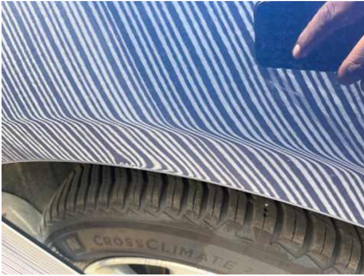
Seitenteil hinten links (Delle)
