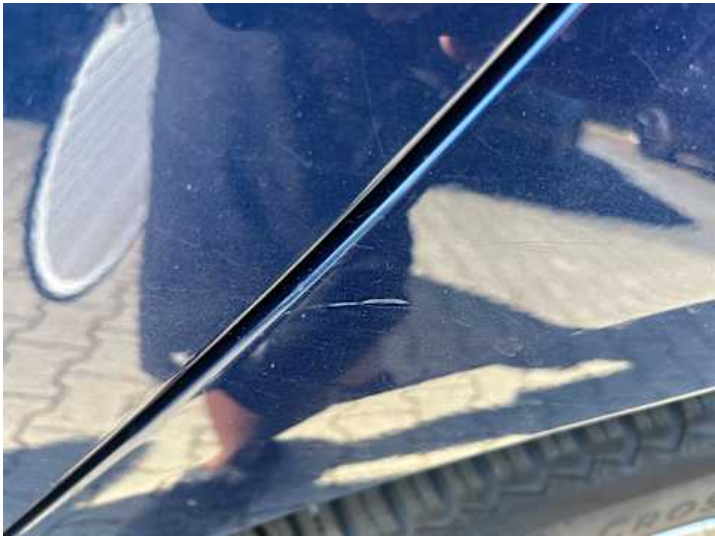
Seitenteil hinten links (Kratzer, Lackschaden)
