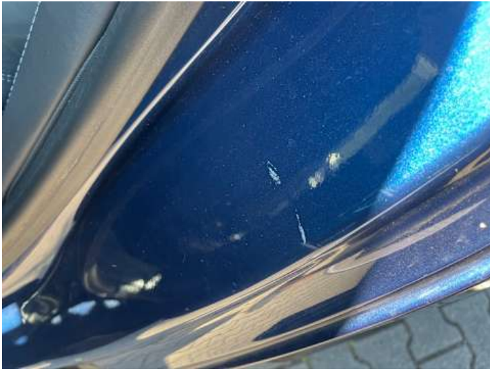
Türe hinten links (Kratzer, Lackschaden)
