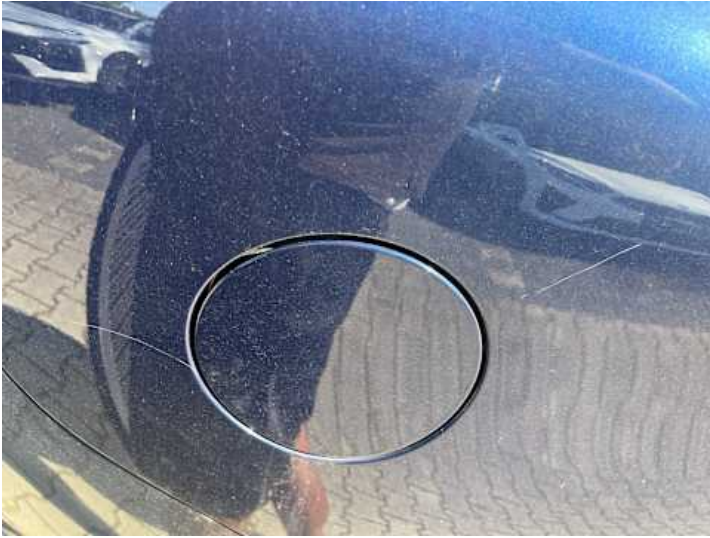
Seitenteil hinten rechts (Kratzer, Lackschaden)
