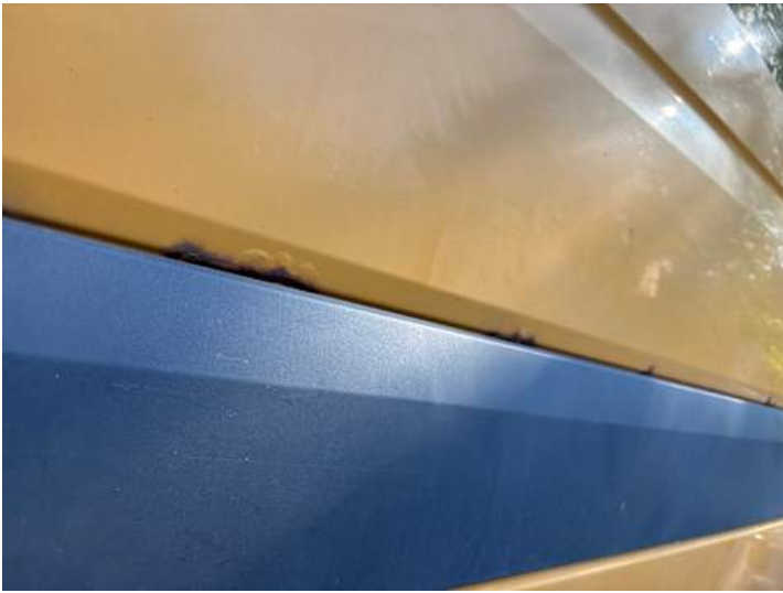
Seitenteil hinten links (Lackschaden, Rost)
