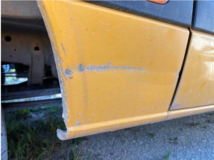
Seitenteil hinten rechts (Verformung, Lackschaden)
