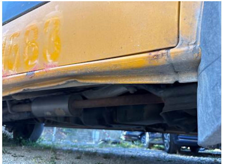
Schweller rechts (Verformung)
