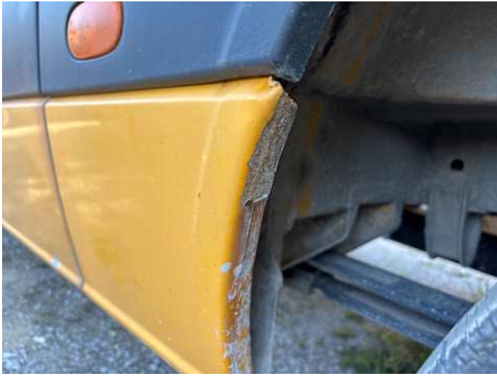
Seitenteil hinten links (Lackschaden, Rost)
