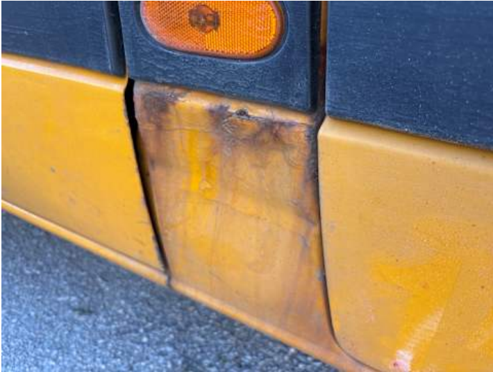
Seitenteil hinten rechts (Verformung, Lackschaden)
