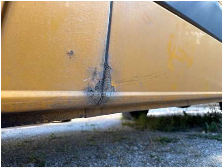
Seitenteil hinten links (Lackschaden, Rost)
