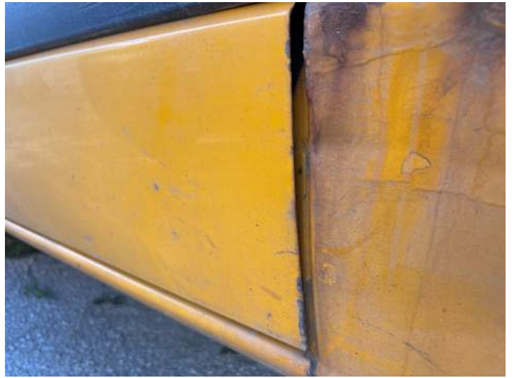
Türe hinten rechts (Lackschaden)
