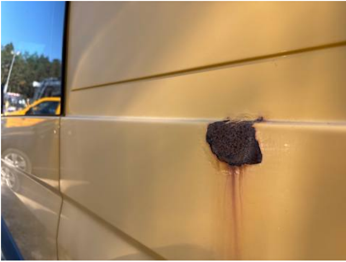
Seitenteil hinten links (Lackschaden, Rost)
