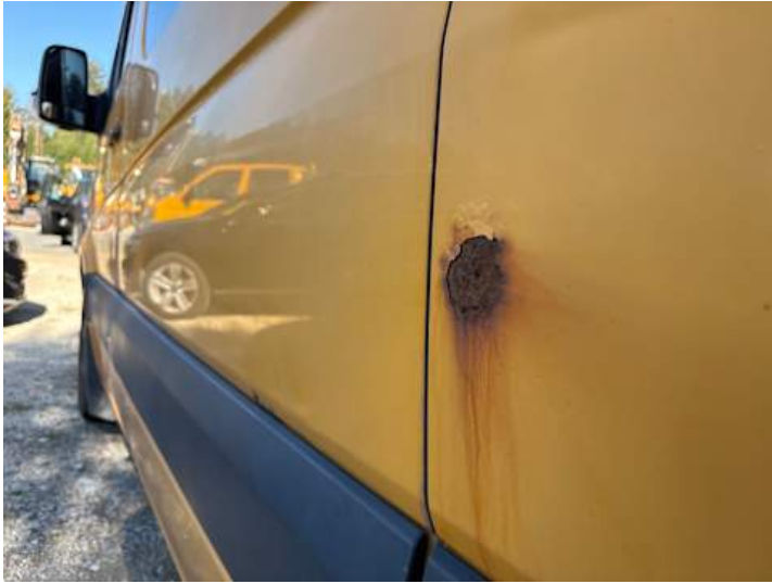
Seitenteil hinten links (Lackschaden, Rost)
