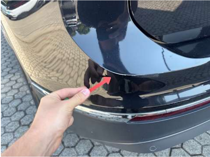
Stoßstange hinten (Lackschaden, Kratzer)
