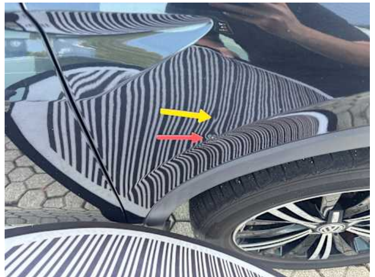
Kotflügel vorne rechts (Kratzer, Lackschaden, Delle)
