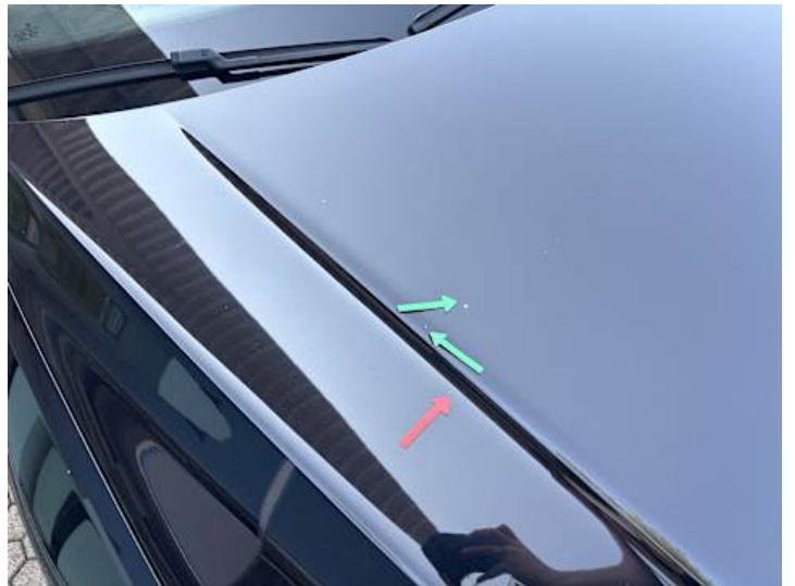
Motorhaube (Lackschaden, Steinschlag)
