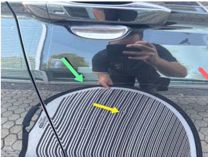
Beifahrertür (Kratzer, Delle, Lackschaden)
