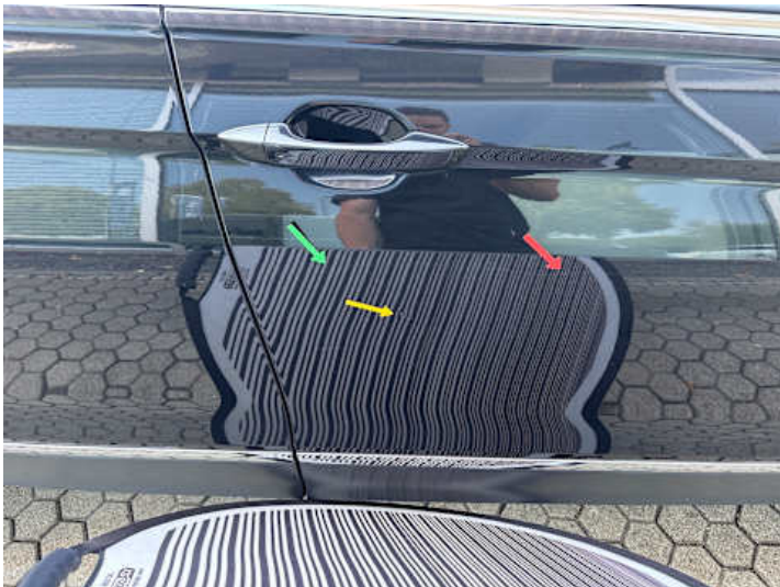
Beifahrer ­ tür (Kratzer, Delle, Lackschaden)
