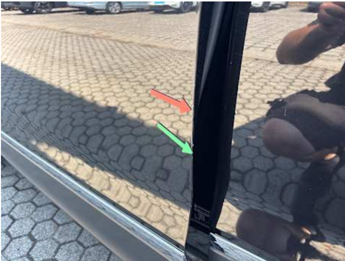
Fahrer ­ tür (Lackschaden, Kratzer)
