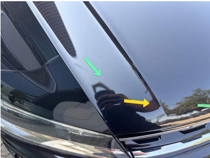
Motorhaube (Lackschaden, Steinschlag)
