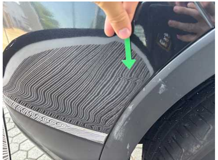
Stoßstange hinten (Unsachgemäß instand gesetzt, Lackschaden, Ausgeblichen/Matt, Verformung)
