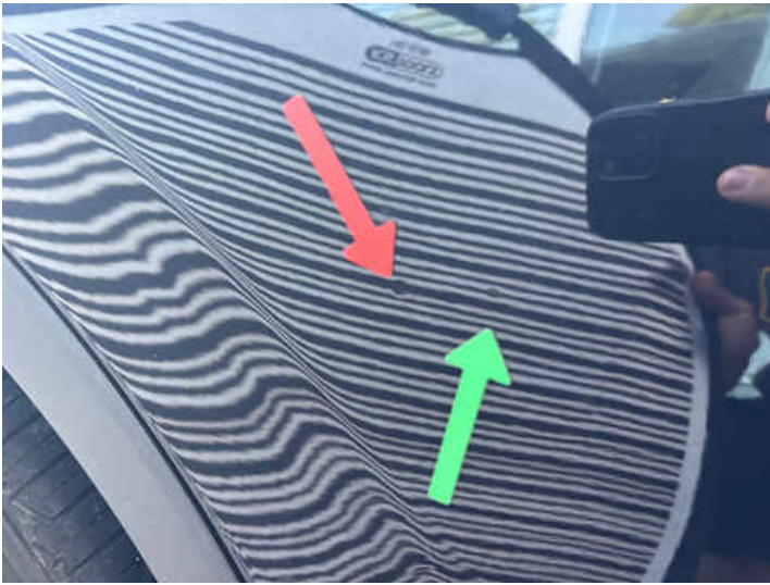
Türe hinten rechts (Lackschaden, Unsachgemäß instand gesetzt, Delle)
