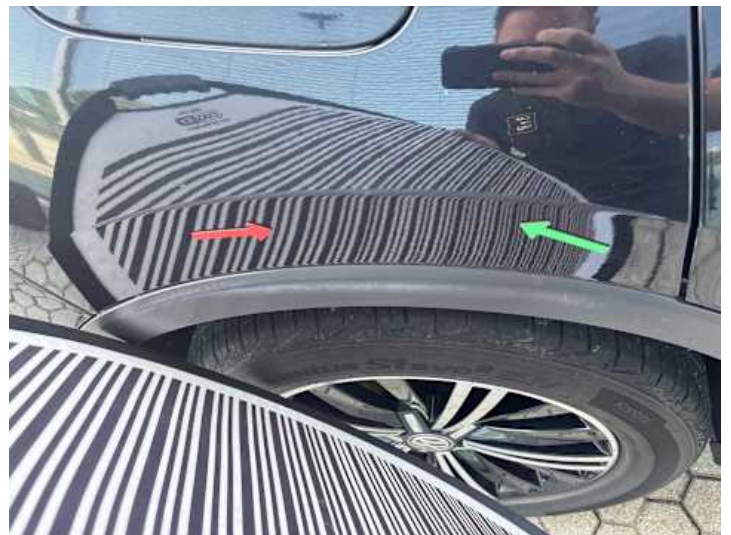
Seitenteil hinten rechts (Lackschaden, Unsachgemäß instand gesetzt)
