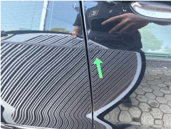
Beifahrer ­ tür (Kratzer, Delle, Lackschaden)
