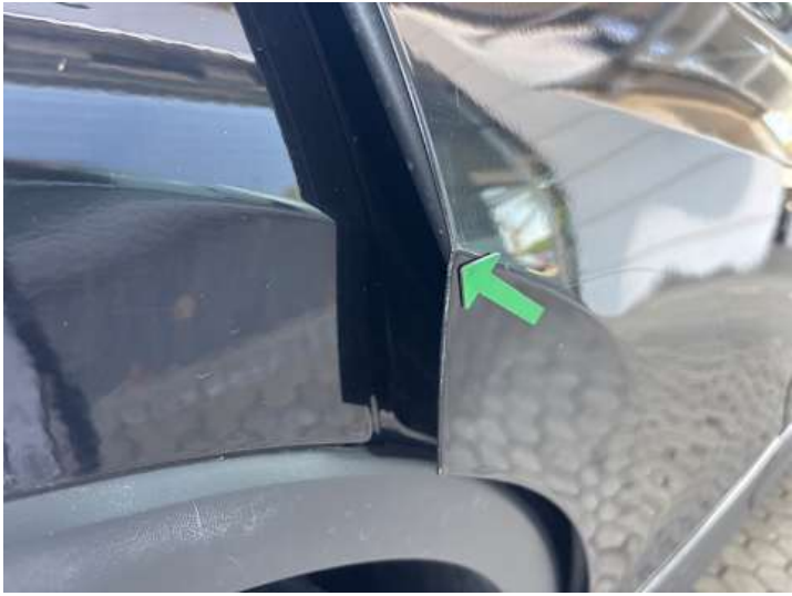
Türe hinten rechts (Lackschaden, Unsachgemäß instand gesetzt, Delle)
