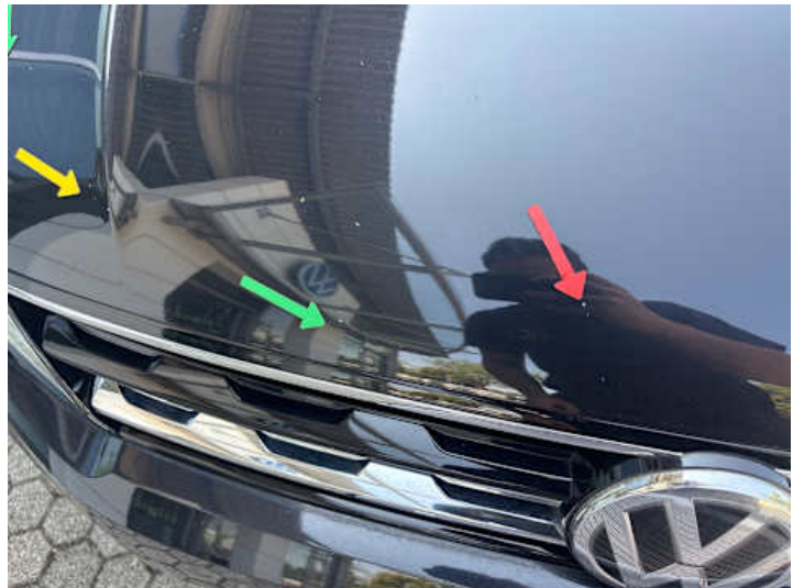
Motorhaube (Lackschaden, Steinschlag)
