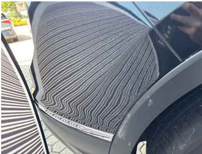
Stoßstange hinten (Unsachgemäß instand gesetzt, Lackschaden, Ausgeblichen/Matt, Verformung)
