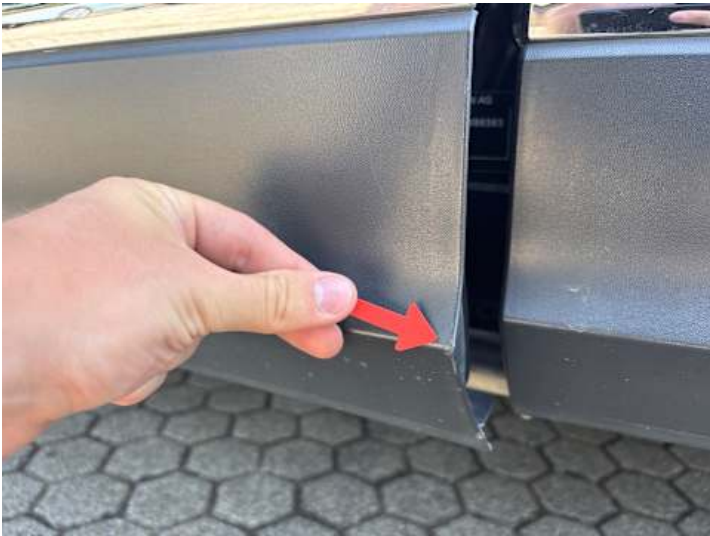
Fahrer ­ tür (Lackschaden, Kratzer)
