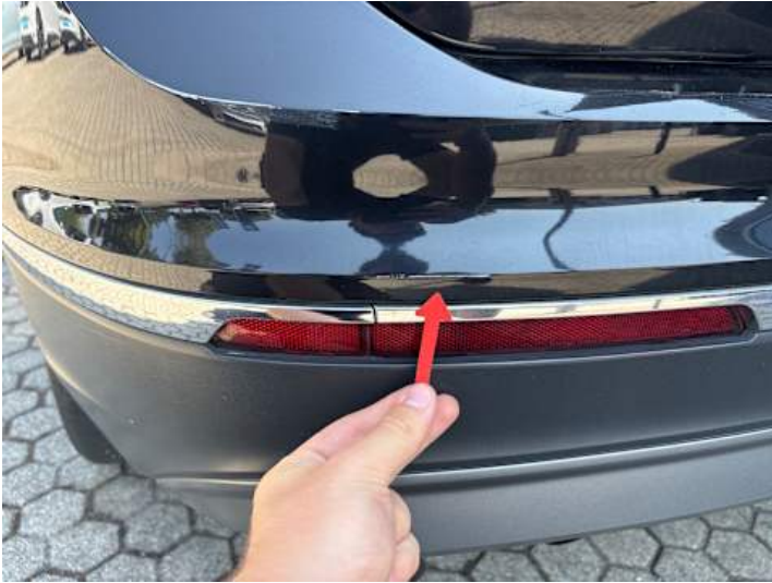
Stoßstange hinten (Lackschaden, Kratzer)
