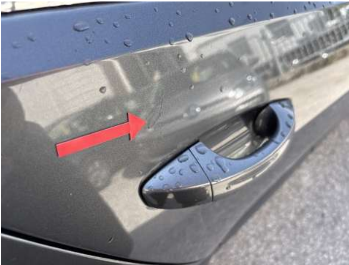
Türe hinten rechts (Kratzer)
