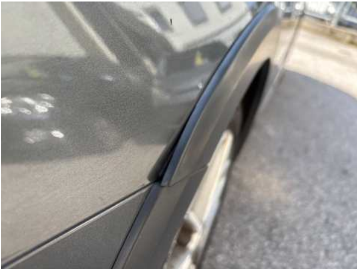
Seitenteil hinten rechts (Spaltmaße ungenau)
