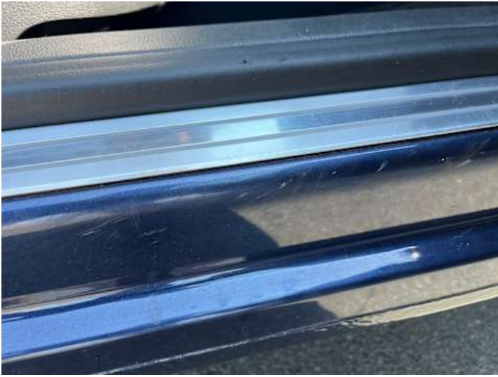
Schweller rechts (Kratzer, Delle)
