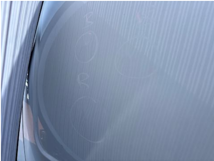
Seitenteil hinten links (Verformung, Delle)
