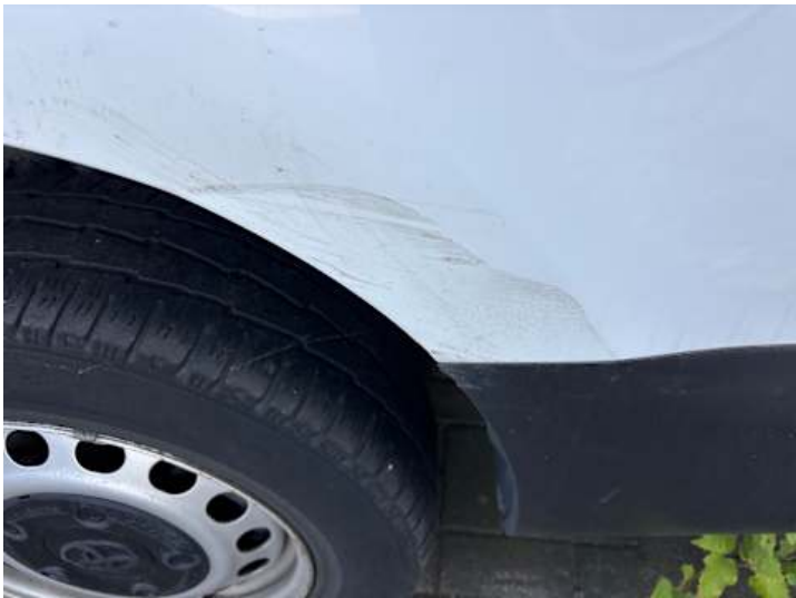
Seitenteil hinten links (Kratzer, Verformung)
