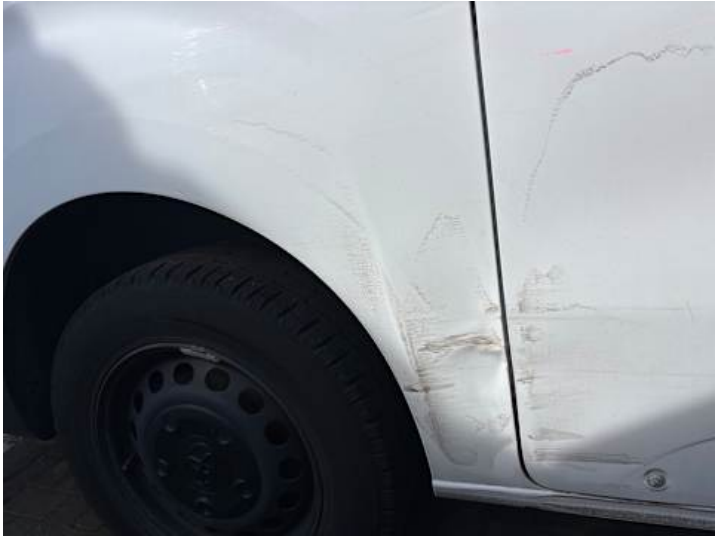
Seitenteil hinten rechts (Kratzer, Verformung)
