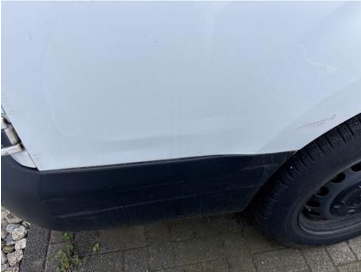
Seitenteil hinten rechts (Kratzer, Verformung)
