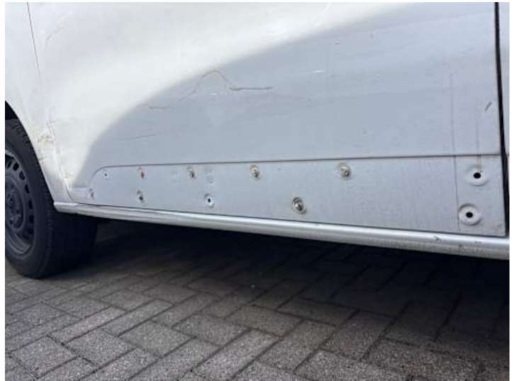
Türe hinten rechts (Riss/Bruch)
