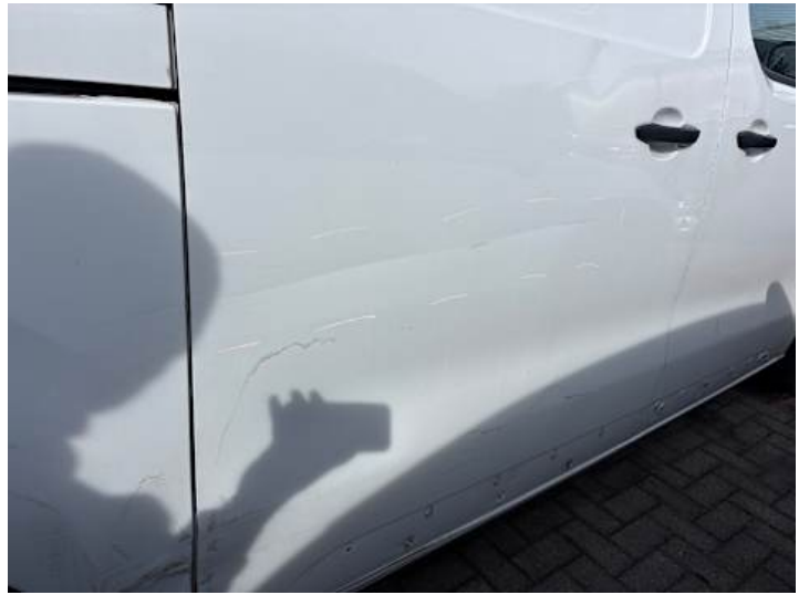
Türe hinten rechts (Kratzer, Verformung, Delle)
