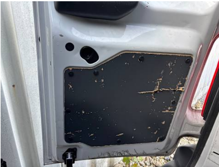
Innenraum (Kratzer, Riss/Bruch)
