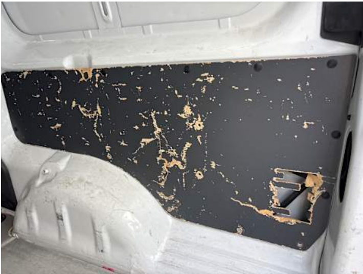
Innenraum (Kratzer, Riss/Bruch)
