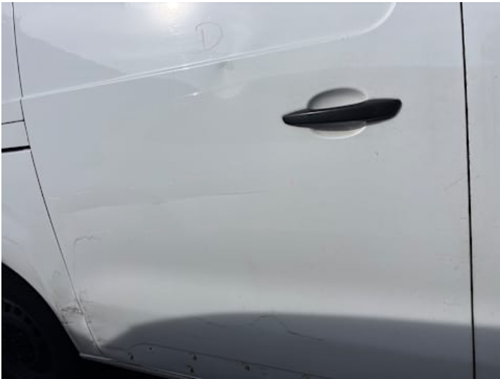
Türe hinten rechts (Kratzer, Verformung, Delle)
