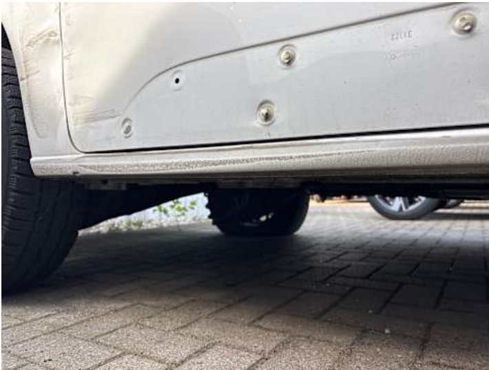
Schweller rechts (Kratzer, Verformung)
