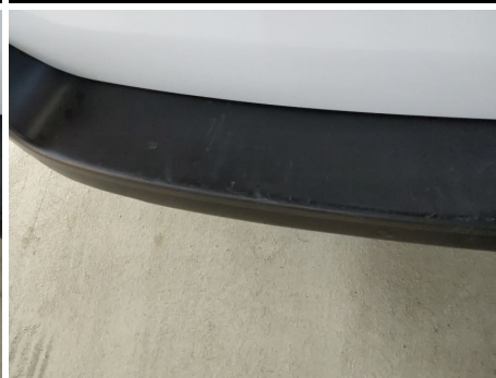
Stoßfänger / Hinten / Gebrochen
