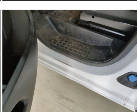
Türeinstieg / Vorne Links / Kratzer
