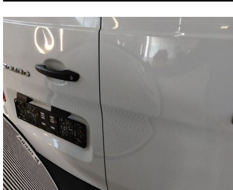
Heckklappe / Kofferraumtür / Hinten Rechts / Delle
