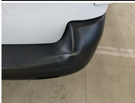
Stoßfänger / Hinten / Gebrochen
