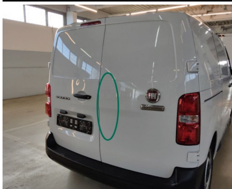
Heckklappe / Kofferraumtür / Hinten Rechts / Delle
