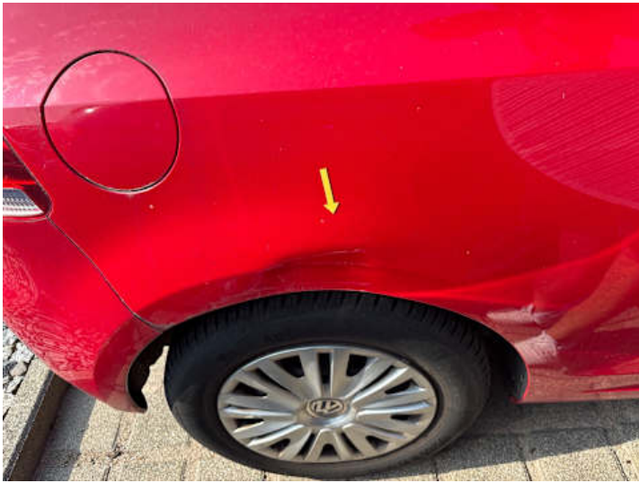
Seitenteil hinten rechts (Verformung)
