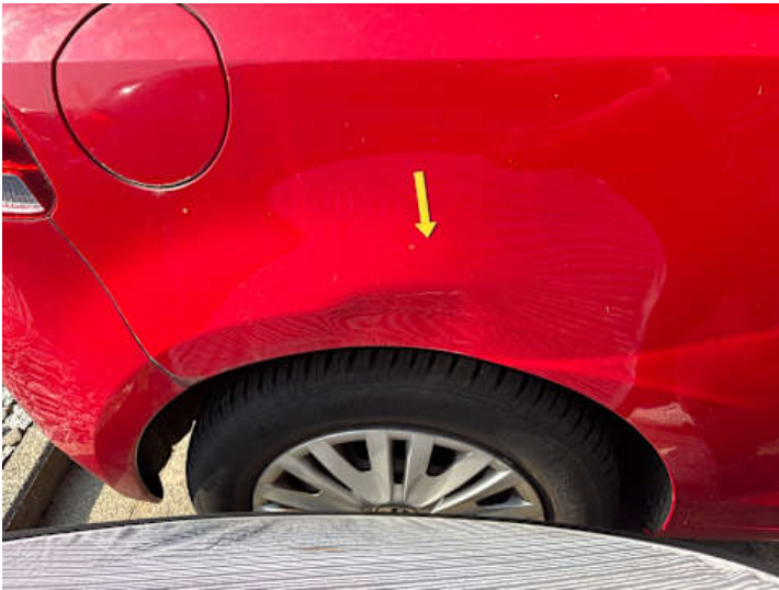
Seitenteil hinten rechts (Verformung)
