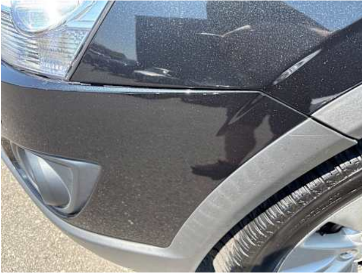
Stoßstange vorne (Spaltmaße ungenau)
