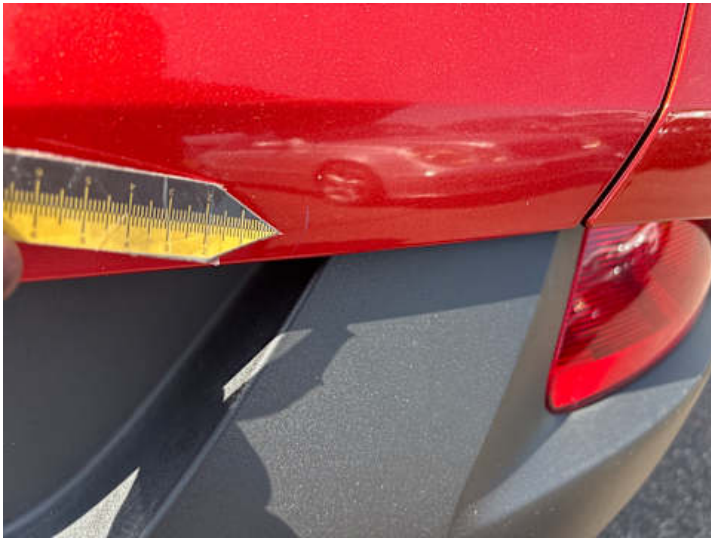
Heckklappe (Lackschaden, Kratzer)
