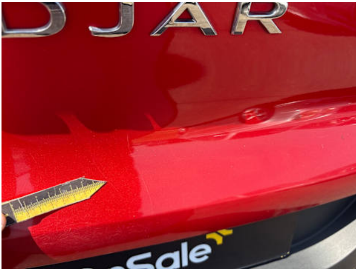
Heckklappe (Lackschaden, Kratzer)
