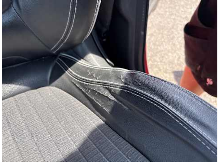
Innenraum (Verschleiß, Riss/Bruch)
