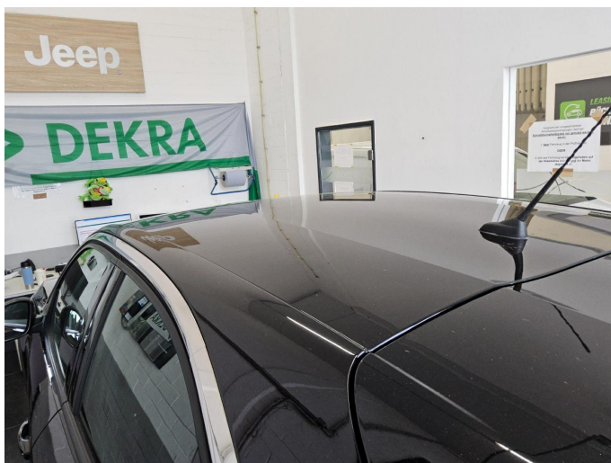
Bild 15: Außen, Dach, mehrfach eingedellt, drücken
