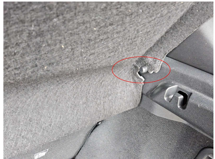
Bild 2: Innen, Gepäckraumabdeckung - Hutablage, verschlissen, erneuern
