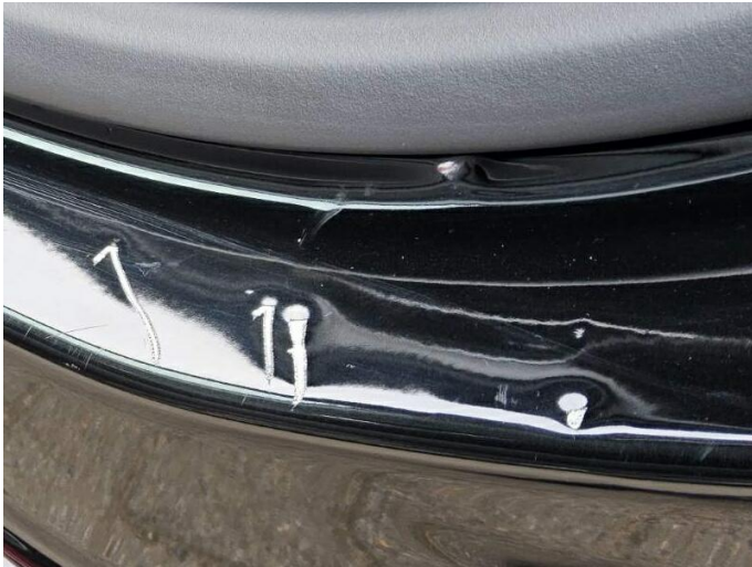
Bild 9: Außen, Tür vorne links - Einstieg, zerschrammt und eingedellt , drücken und lackieren
