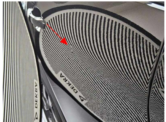
Bild 20: Außen, Tür hinten rechts, eingedellt, drücken
