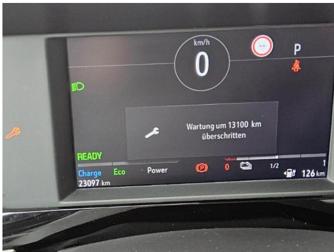
Bild 7: Technik, Service/Inspektion - Wartung, überfällig, durchführen
