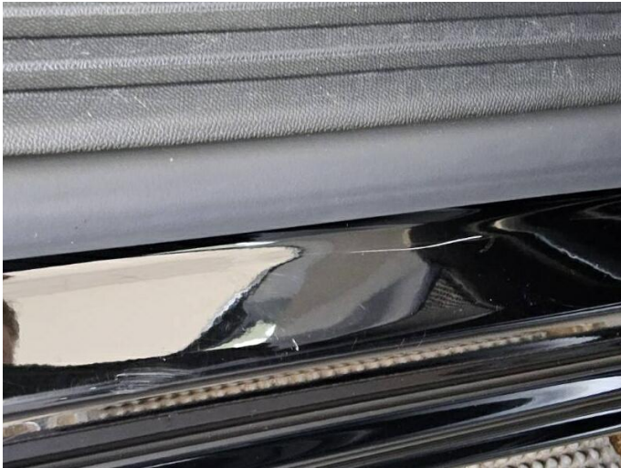
Bild 25: Außen, Tür vorne rechts - Einstieg Lackierung, verschrammt, lackieren
