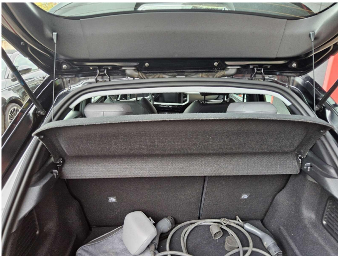
Bild 1: Innen, Gepäckraumabdeckung - Hutablage, verschlissen, erneuern
