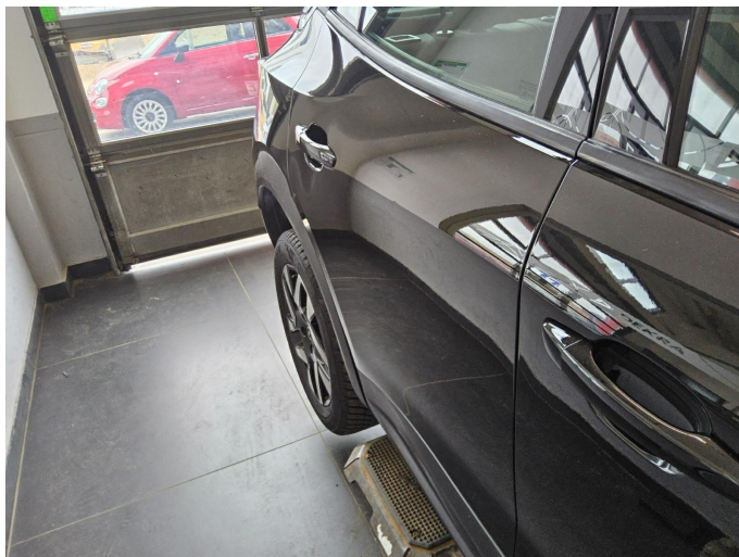
Bild 19: Außen, Tür hinten rechts, eingedellt, drücken
