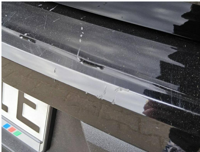
Bild 5: Außen, Stoßfänger hinten - Lackierung, verschrämmt, lackieren mit Lackaufbau
