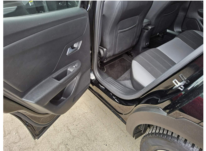
Bild 10: Außen, Tür hinten links - Einstieg Lackierung, verschrammt, lackieren
