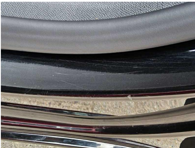
Bild 11: Außen, Tür hinten links - Einstieg Lackierung, verschrammt, lackieren
