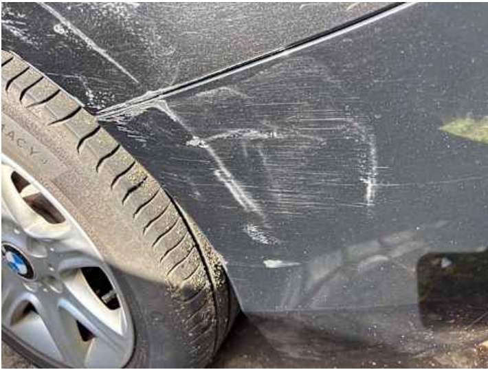
Stoßstange hinten (Kratzer)
