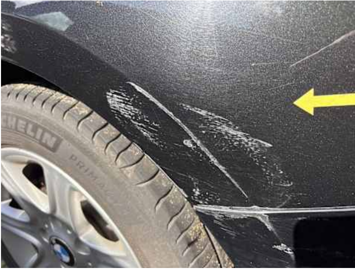
Seitenteil hinten links (Kratzer)
