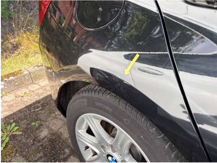
Seitenteil hinten rechts (Kratzer, Delle)
