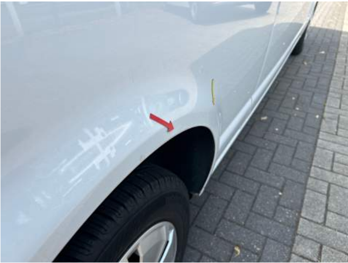
Seitenteil hinten rechts (Kratzer, Verformung)
