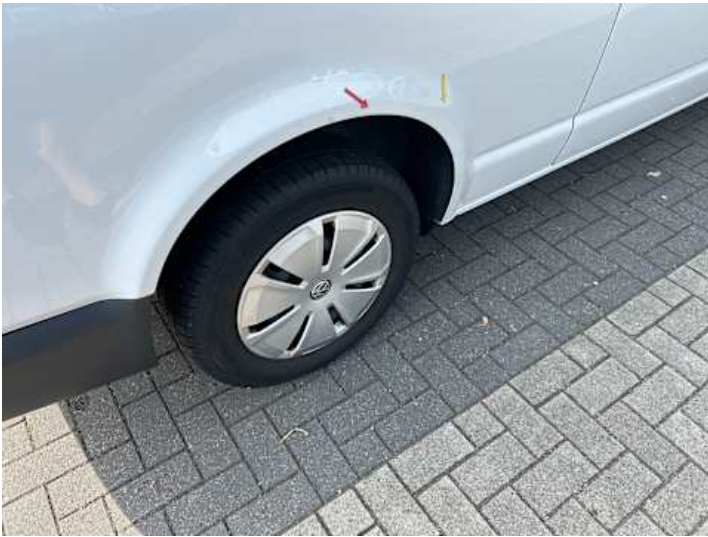
Seitenteil hinten rechts (Kratzer, Verformung)
