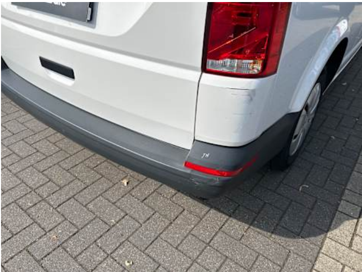
Stoßstange hinten (Spaltmaße ungenau, Lackschaden, Verformung, Riss/Bruch)
