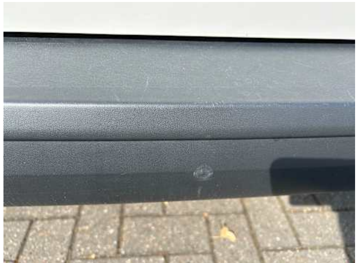
Stoßstange hinten (Spaltmaße ungenau, Lackschaden, Verformung, Riss/Bruch)
