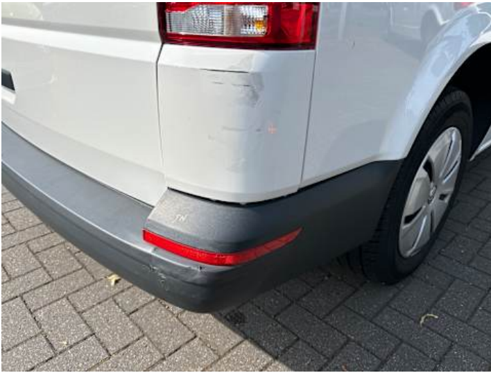
Stoßstange hinten (Spaltmaße ungenau, Lackschaden, Verformung, Riss/Bruch)
