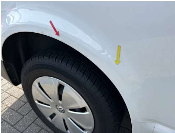
Seitenteil hinten rechts (Kratzer, Verformung)
