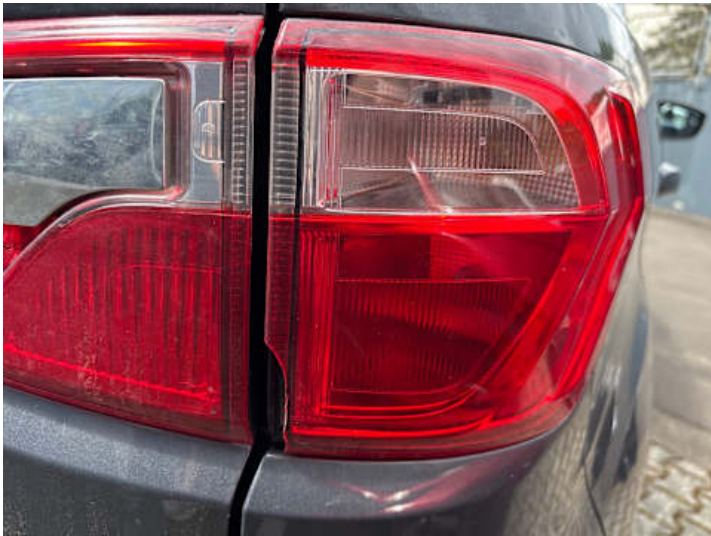
Rücklicht (rechts) (Riss/Bruch)
