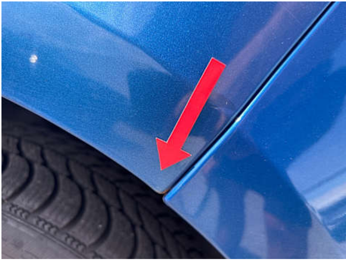
Seitenteil hinten links (Rost)
