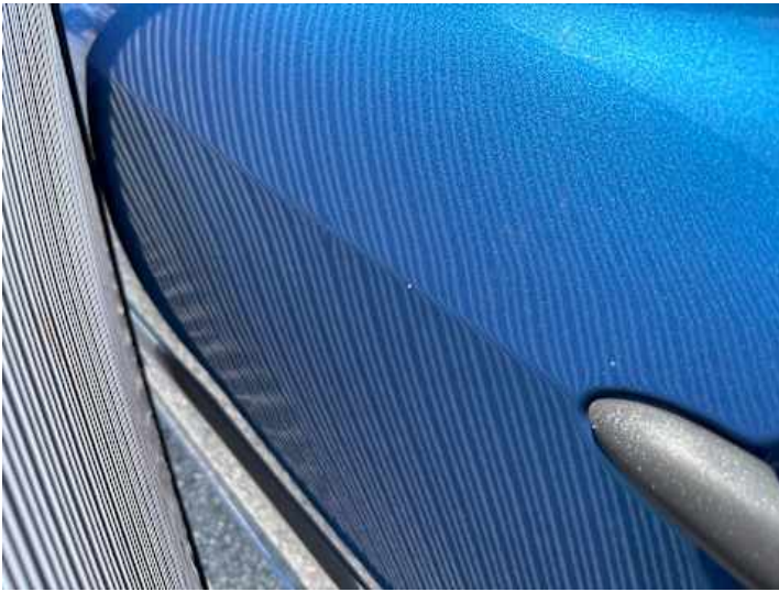
Türe hinten links (Lackschaden, Delle)
