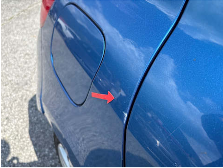
Seitenteil hinten rechts (Kratzer)
