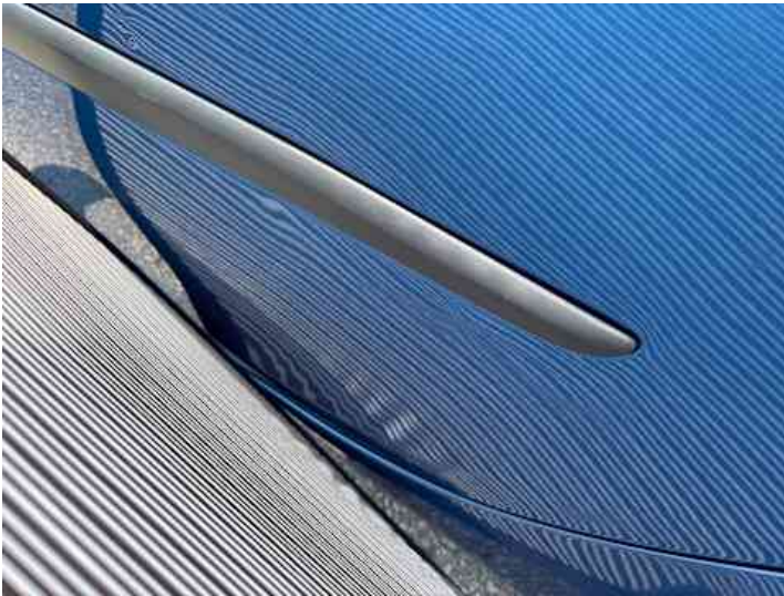
Türe hinten links (Verformung)
