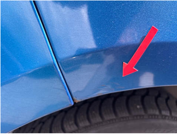
Seitenteil hinten rechts (Kratzer, Rost)
