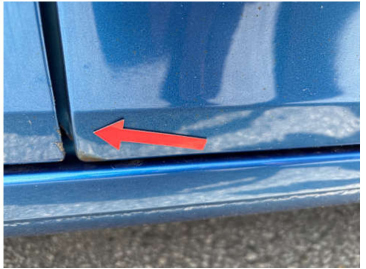
Türe hinten links (Rost)
