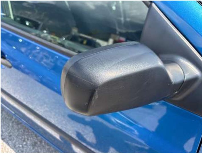
Beifahrertür (Unsachgemäß instand gesetzt, Anderer Schaden): Unlackiert
