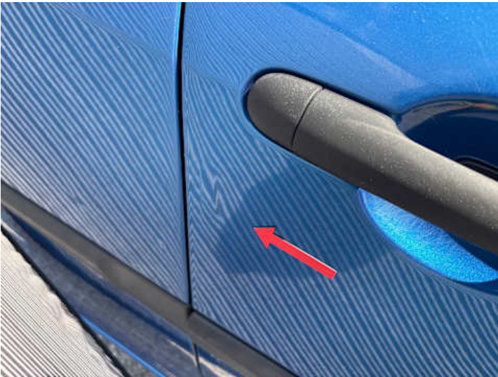
Beifahrertür (Lackschaden, Delle)
