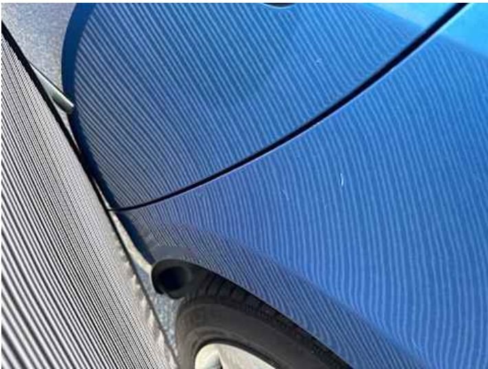
Seitenteil hinten links (Delle)
