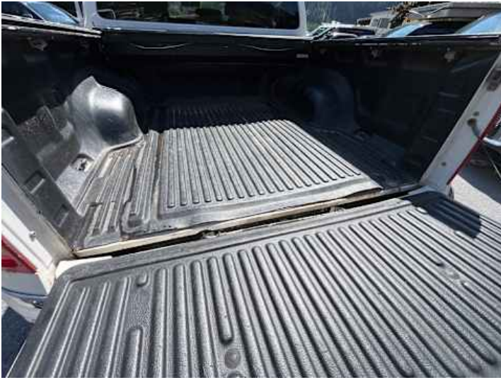
Heckklappe (Lackschaden, Verformung, Kratzer)
