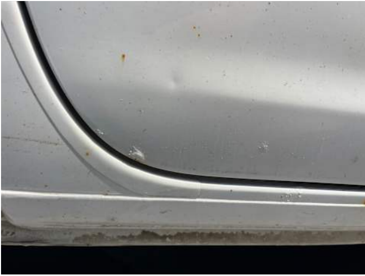
Türe hinten rechts (Lackschaden, Rost)
