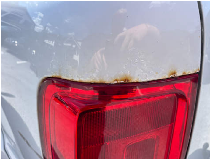
Seitenteil hinten links (Lackschaden, Rost)
