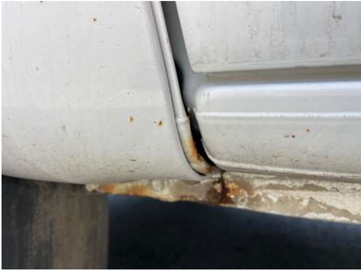
Kotflügel vorne links (Rost, Lackschaden)
