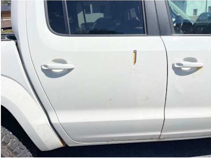
Türe hinten rechts (Lackschaden)
