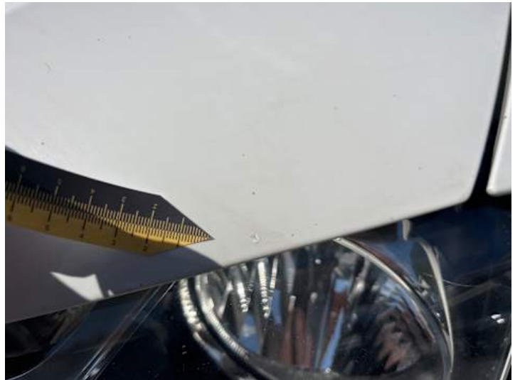
Motorhaube (Lackschaden, Unsachgemäß instand gesetzt)
