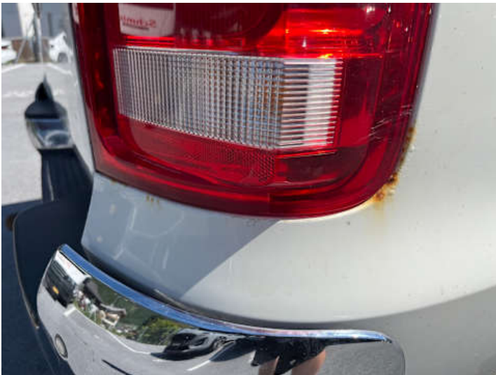
Seitenteil hinten rechts (Lackschaden, Rost)
