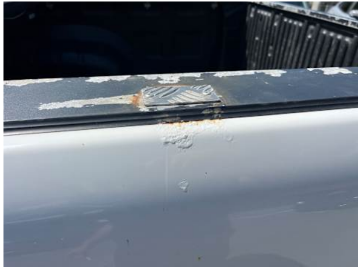
Seitenteil hinten links (Lackschaden, Rost)
