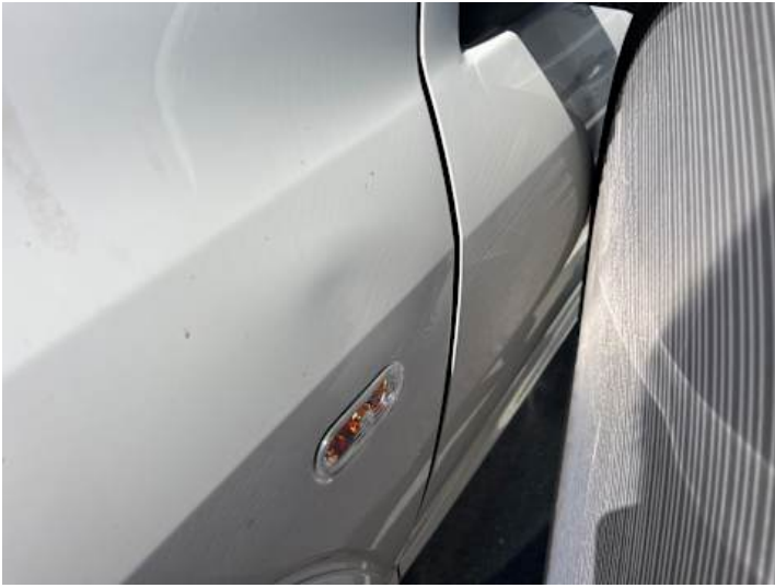
Kotflügel vorne links (Delle)
