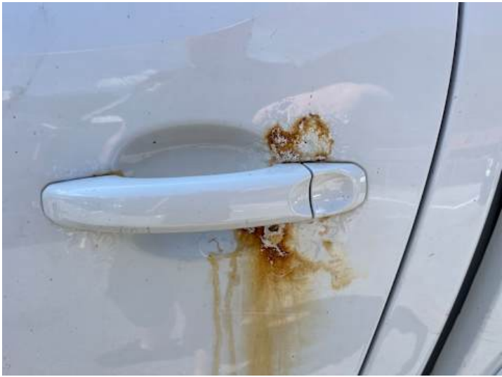
Türe hinten links (Rost, Lackschaden)
