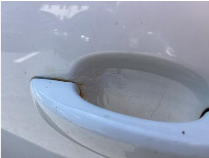
Fahrertür (Rost, Lackschaden)
