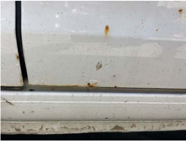
Türe hinten links (Rost, Lackschaden)
