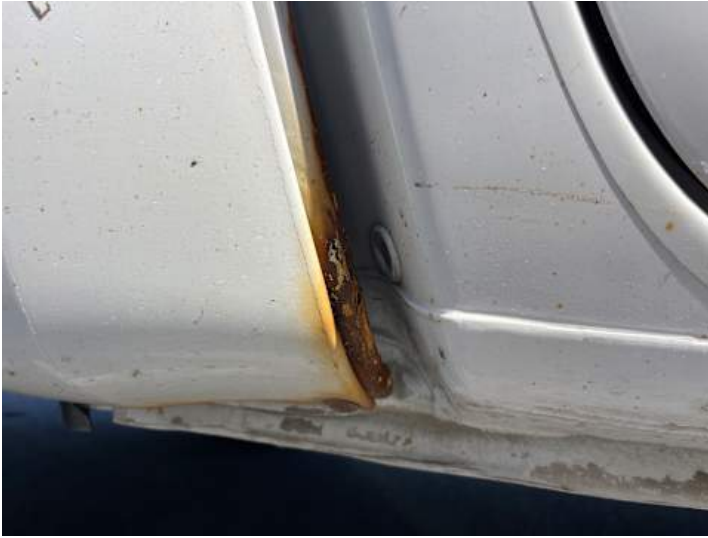
Seitenteil hinten rechts (Lackschaden, Rost)
