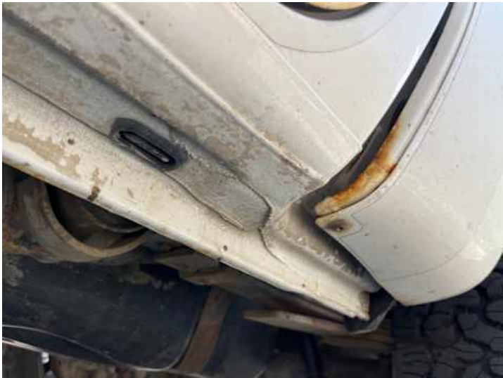
Schweller links (Rost, Lackschaden)
