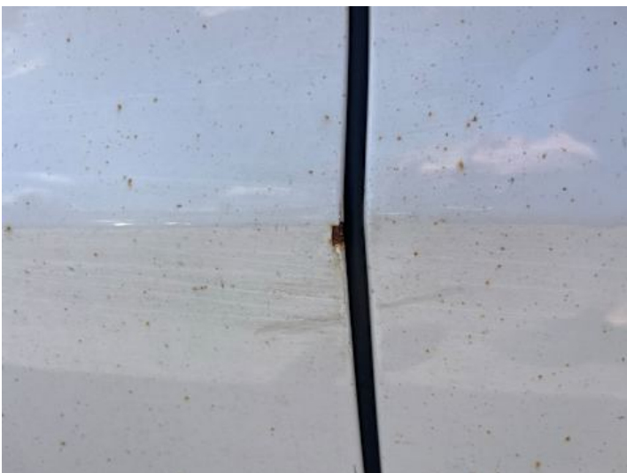
Fahrtür (Rost, Lackschaden)
