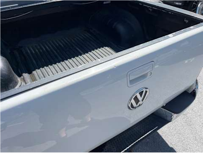
Heckklappe (Lackschaden, Verformung, Kratzer)
