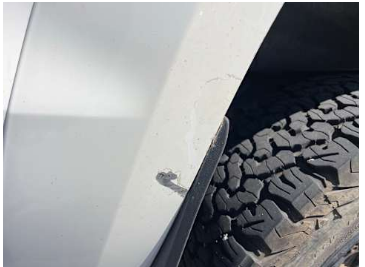
Seitenteil hinten rechts (Lackschaden, Rost)
