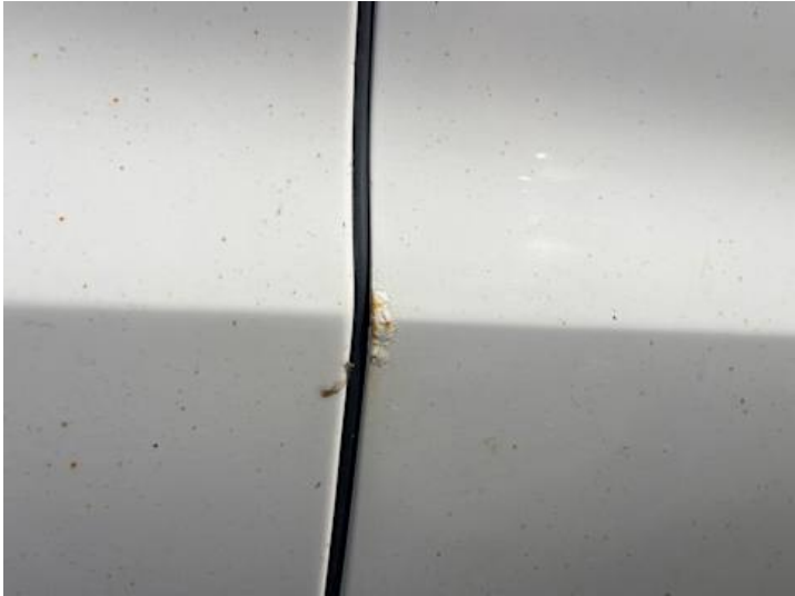
Beifahrertür (Lackschaden, Rost)
