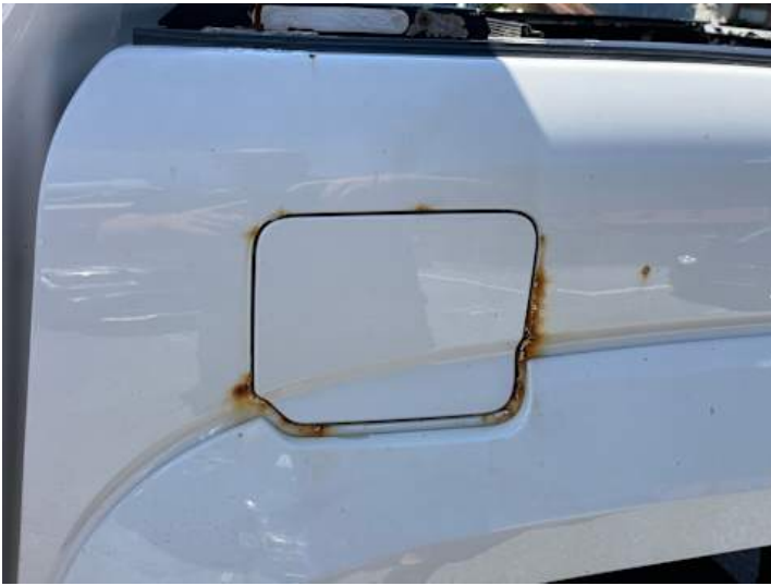
Seitenteil hinten links (Lackschaden, Rost)
