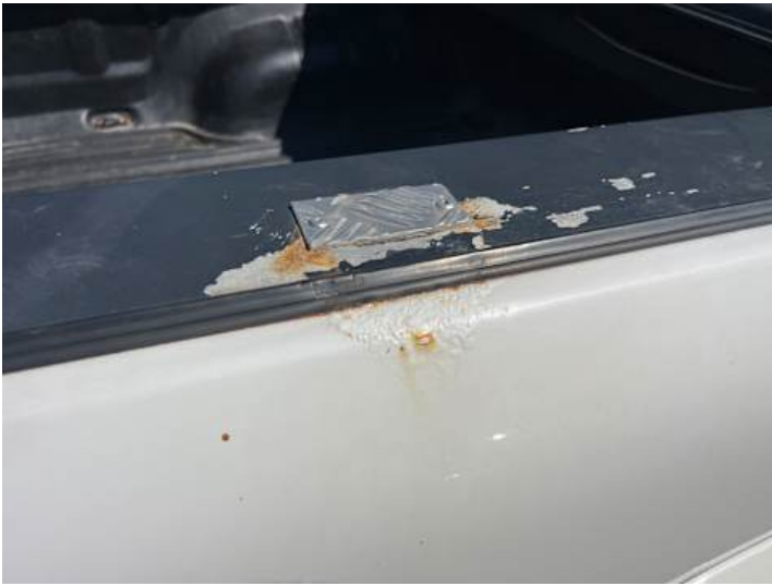
Seitenteil hinten rechts (Lackschaden, Rost)
