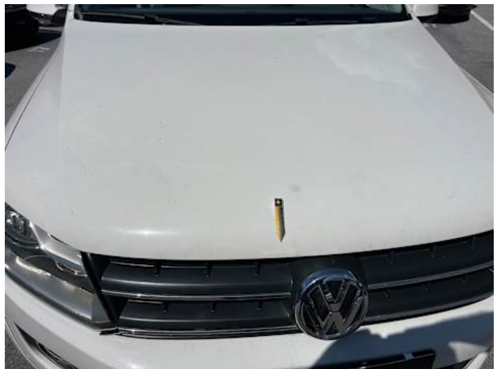
Motorhaube (Lackschaden, Unsachgemäß instand gesetzt)
