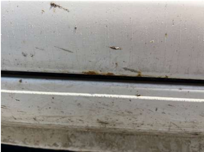
Beifahrertür (Lackschaden, Rost)
