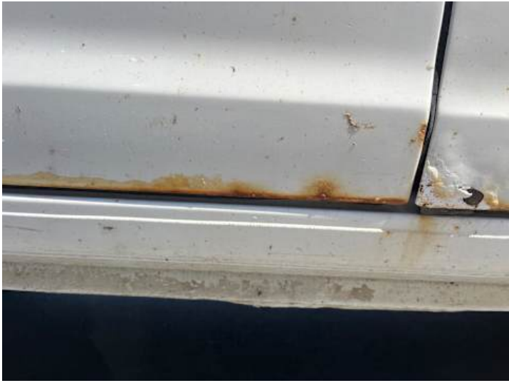
Türe hinten rechts (Lackschaden, Rost)
