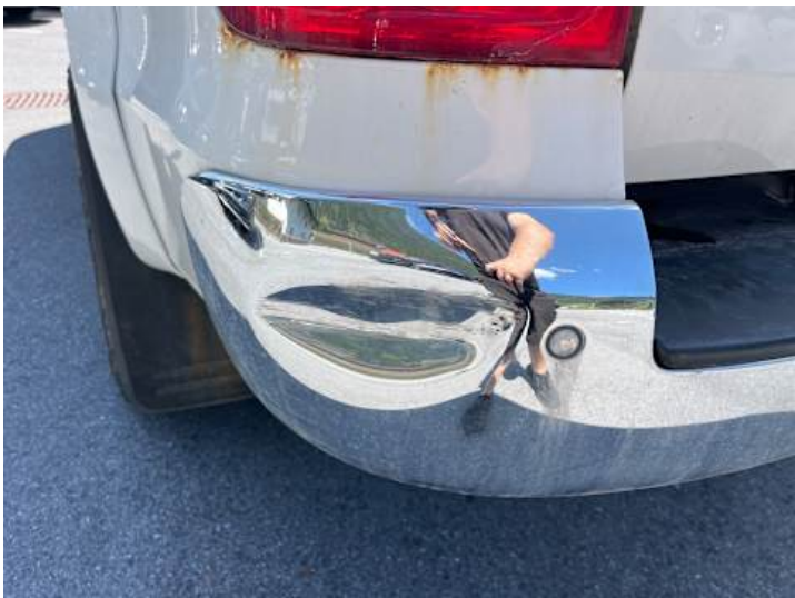
Stoßstange hinten (Verformung)
