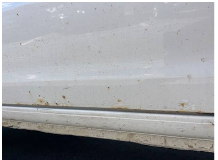
Fahrtür (Rost, Lackschaden)
