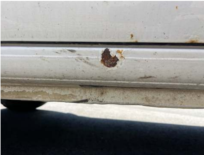
Schweller links (Rost, Lackschaden)
