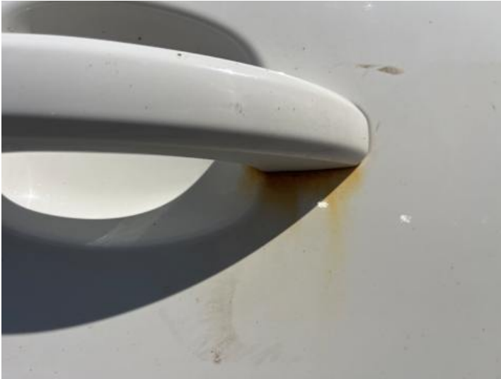
Beifahrertür (Lackschaden, Rost)
