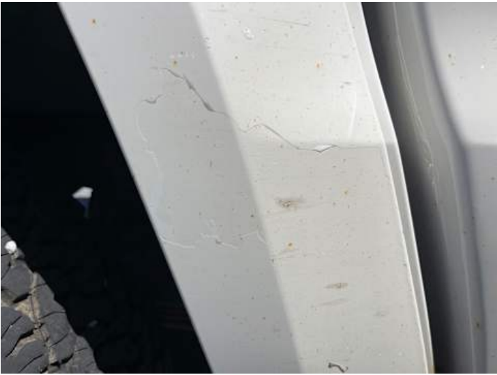
Seitenteil hinten rechts (Lackschaden, Rost)
