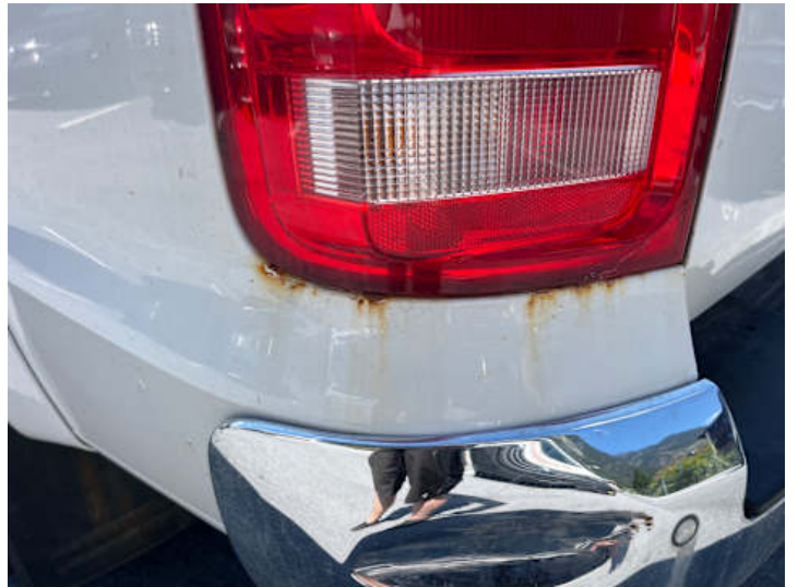
Seitenteil hinten links (Lackschaden, Rost)
