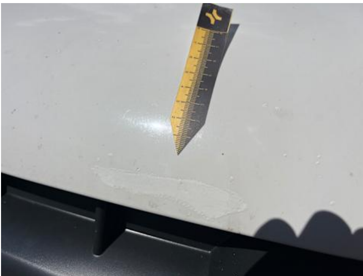
Motorhaube (Lackschaden, Unsachgemäß instand gesetzt)
