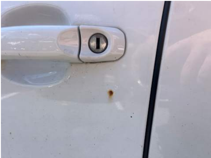
Fahrertür (Rost, Lackschaden)
