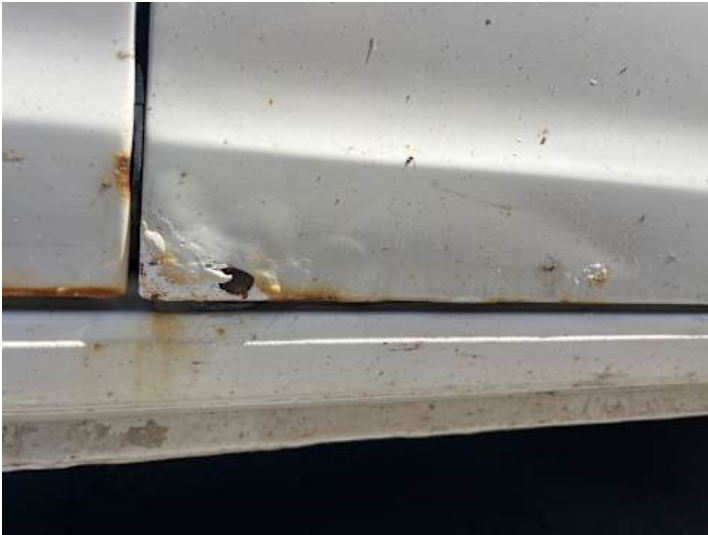
Beifahrertür (Lackschaden, Rost)
