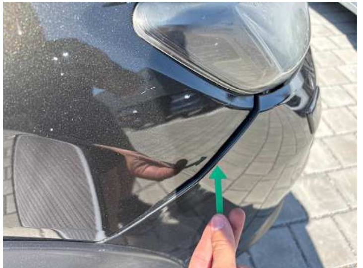
Stoßstange vorne (Spaltmaße ungenau)
