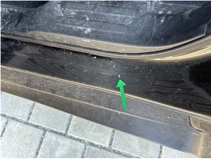
Schweller links (Lackschaden, Delle)
