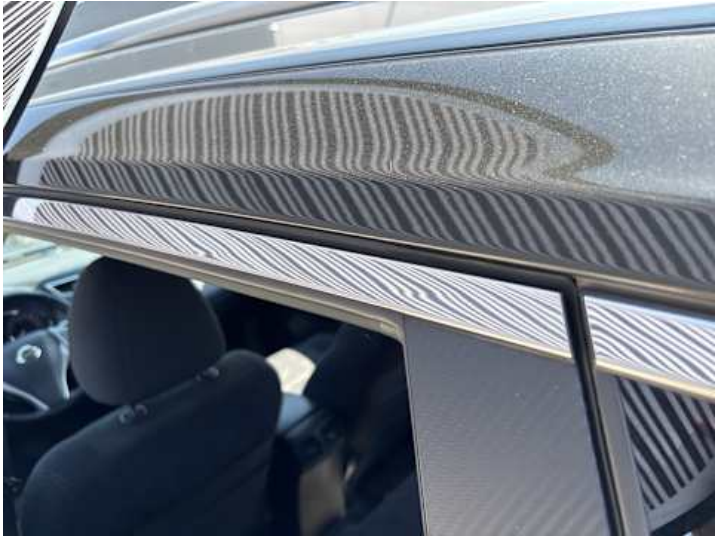
Türe hinten links (Delle)
