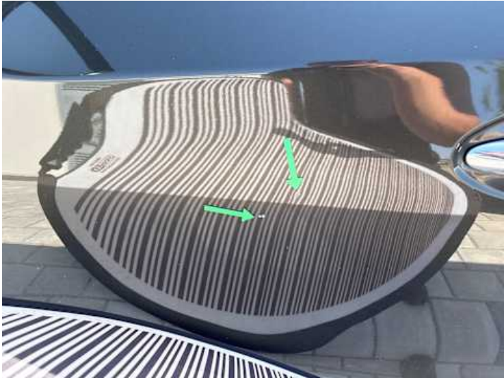
Fahrtür (Kratzer, Lackschaden, Delle)
