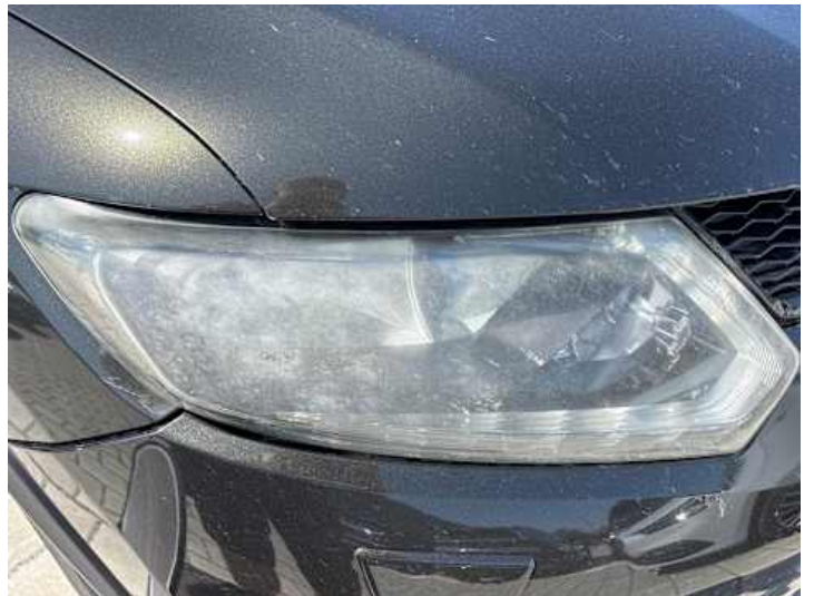
Scheinwerfer (rechts) (Blind, Kratzer)
