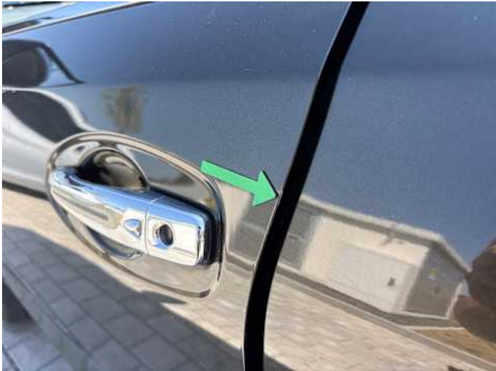
Fahrtür (Kratzer, Lackschaden, Delle)
