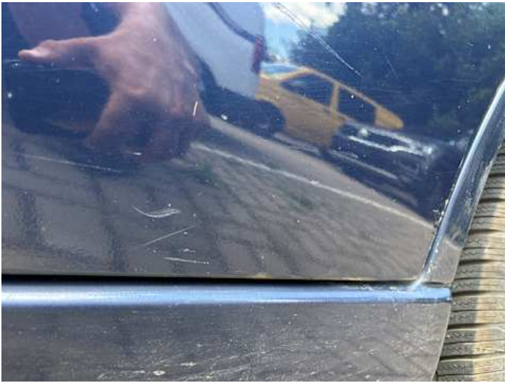
Türe hinten links (Delle, Rost, Unsachgemäß instand gesetzt)
