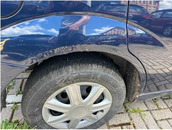
Seitenteil hinten rechts (Rost)
