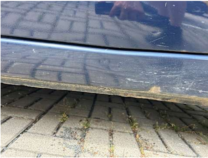
Schweller links (Rost, Delle)
