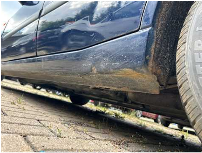
Schweller links (Rost, Delle)
