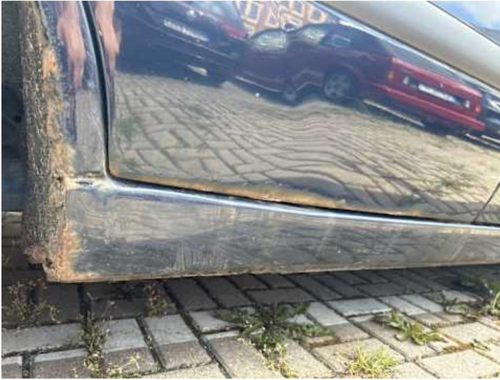
Türe hinten rechts (Rost)
