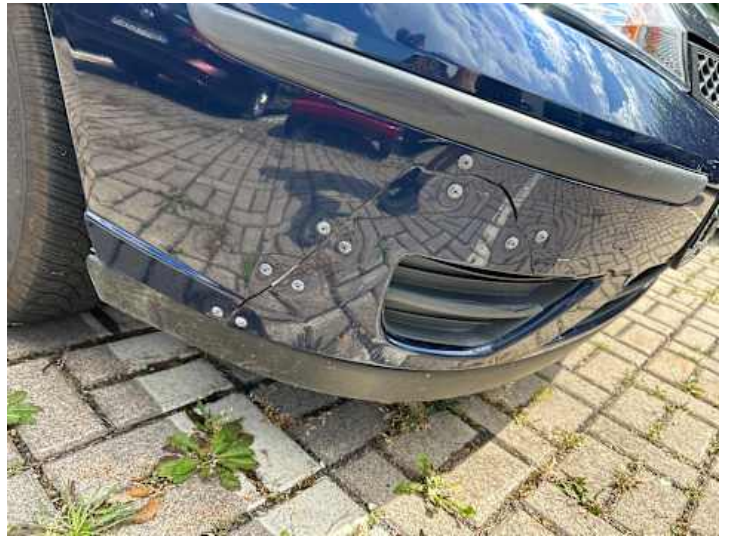
Stoßstange vorne (Riss/Bruch, Unsachgemäß instand gesetzt)
