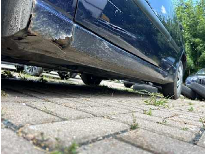
Schweller links (Rost, Delle)
