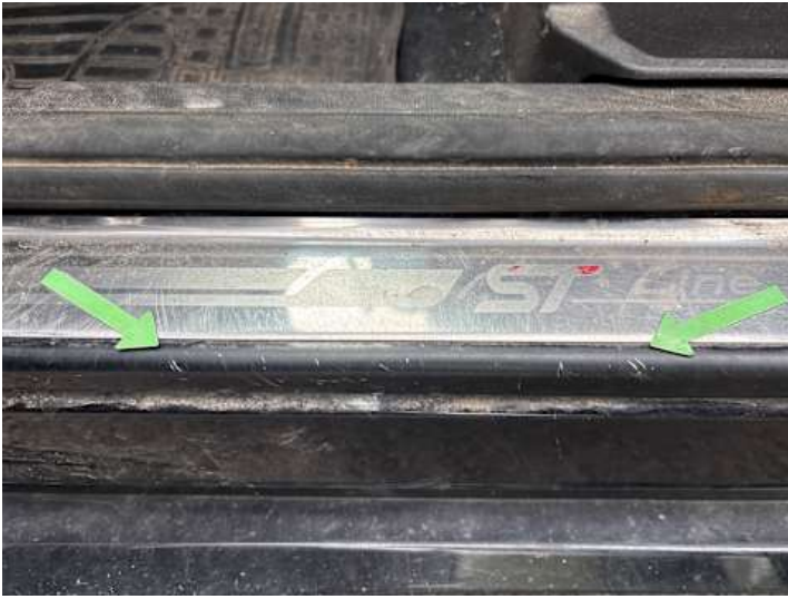
Schweller links (Kratzer)
