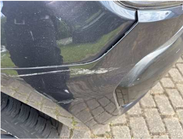
Stoßstange vorne (Spaltmaße ungenau)
