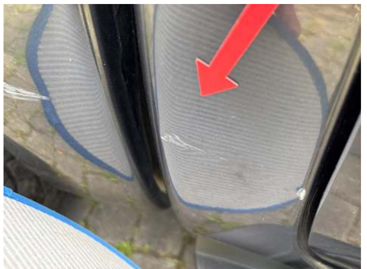
Seitenteil hinten rechts (Kratzer, Verformung)
