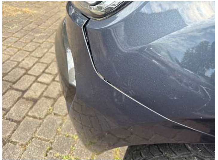
Stoßstange vorne (Spaltmaße ungenau)
