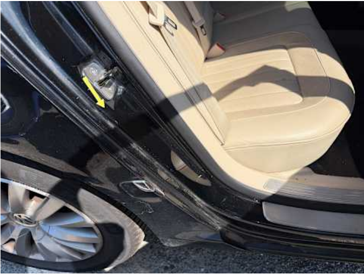
Türe hinten rechts (Kratzer, Lackschaden)
