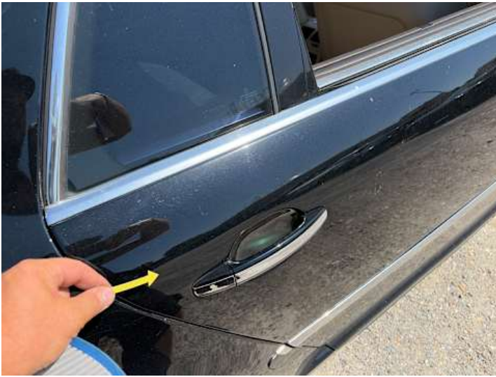
Türe hinten rechts (Kratzer, Lackschaden)
