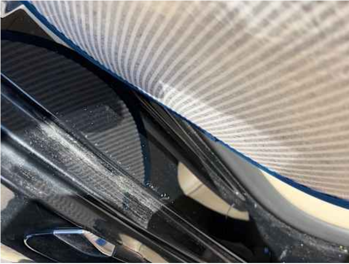
Türe hinten rechts (Kratzer, Lackschaden)
