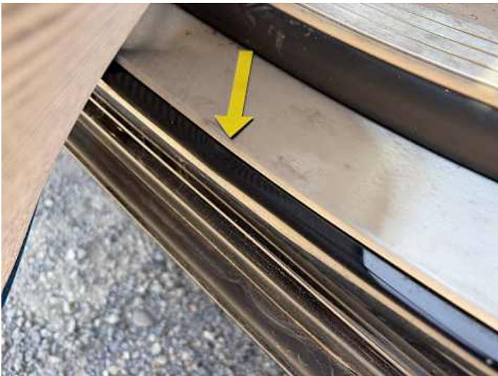
Türe hinten links (Kratzer, Delle)
