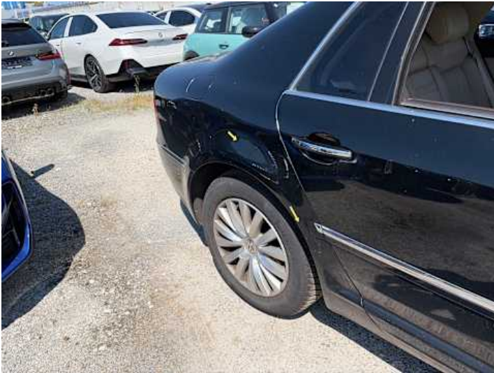
Seitenteil hinten rechts (Lackschaden, Kratzer)
