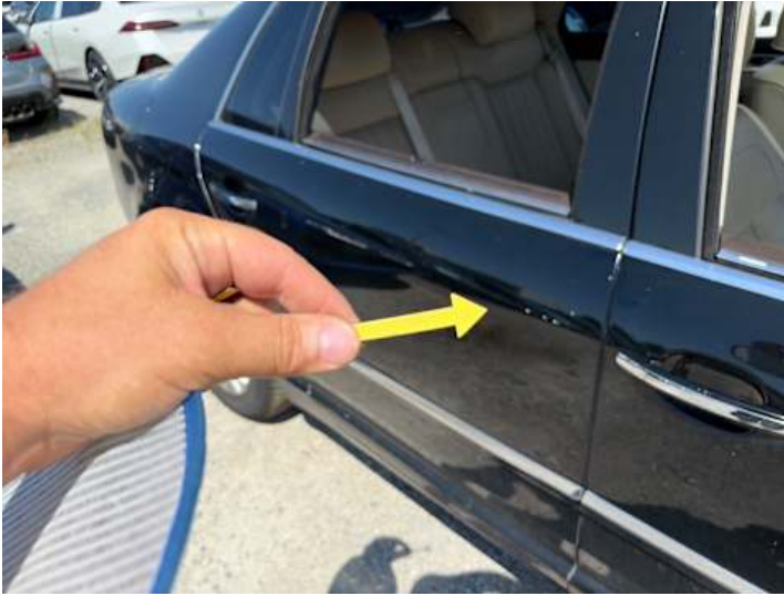
Türe hinten rechts (Kratzer, Lackschaden)
