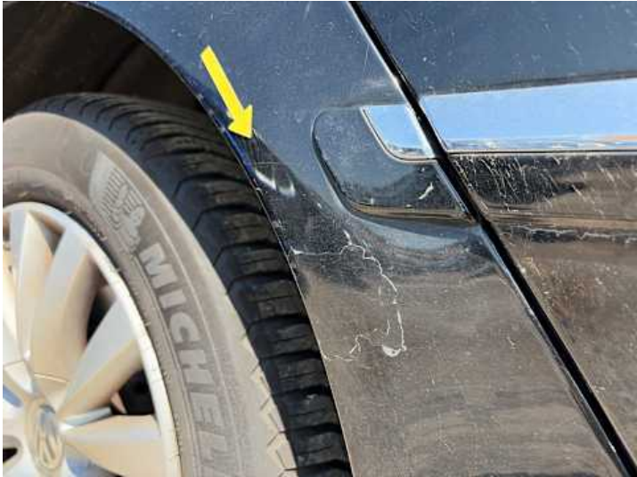
Seitenteil hinten rechts (Lackschaden, Kratzer)
