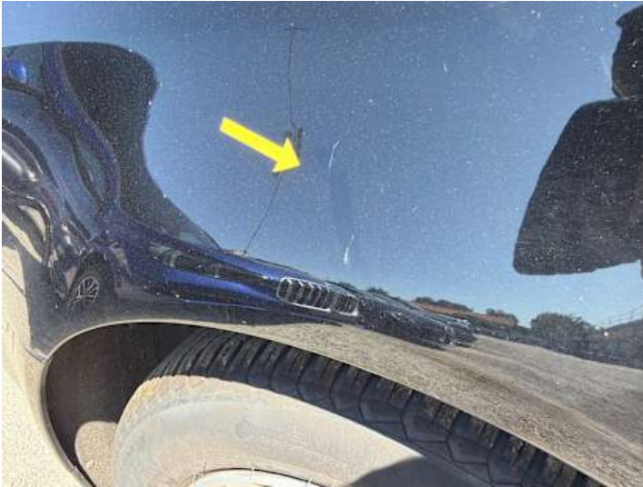
Seitenteil hinten rechts (Lackschaden, Kratzer)
