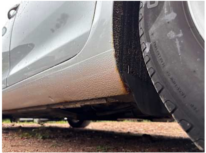
Schweller links (Rost, Kratzer)
