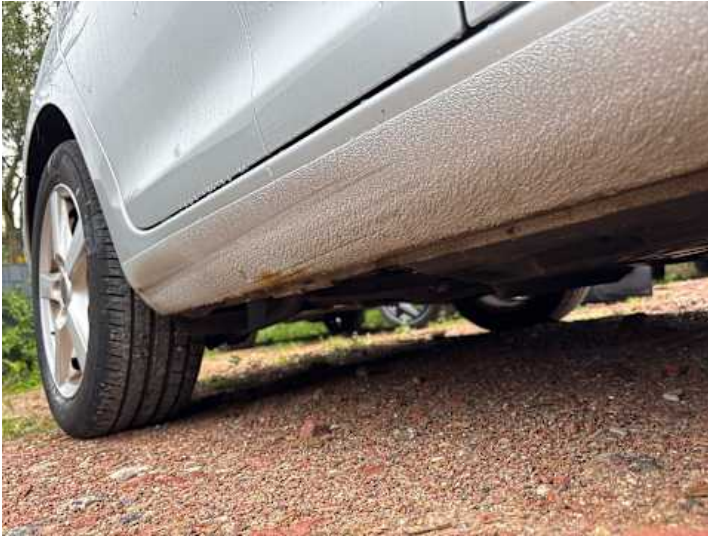
Schweller rechts (Verformung, Kratzer, Rost)
