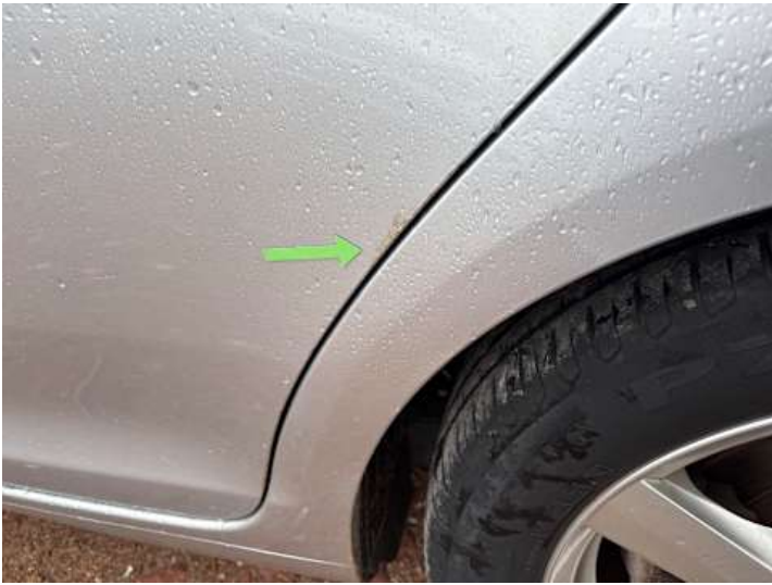
Türe hinten links (Rost, Lackschaden)
