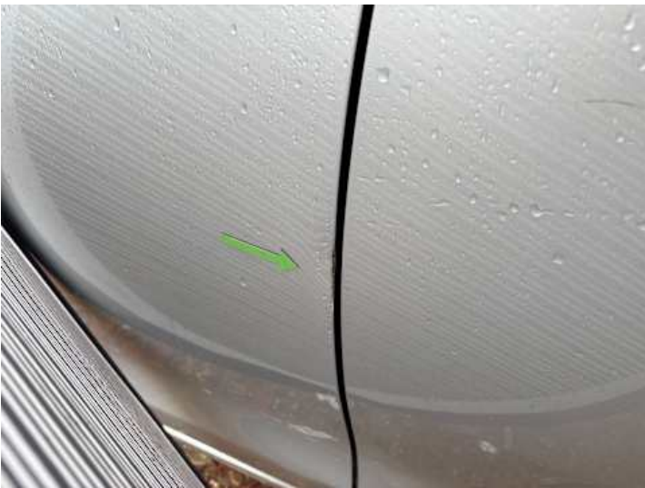
Fahrtür (Kratzer, Verformung, Rost)
