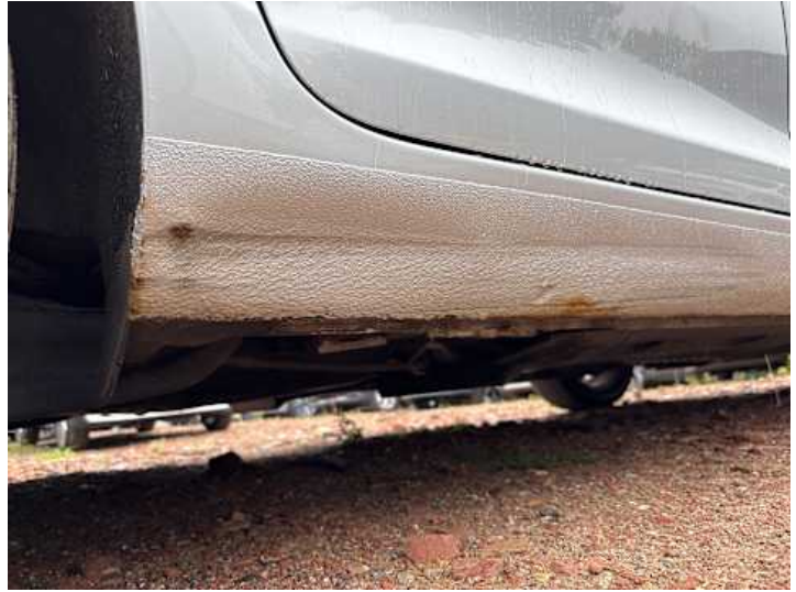
Schweller rechts (Verformung, Kratzer, Rost)
