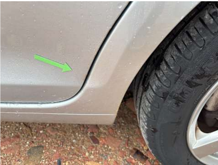
Türe hinten links (Rost, Lackschaden)
