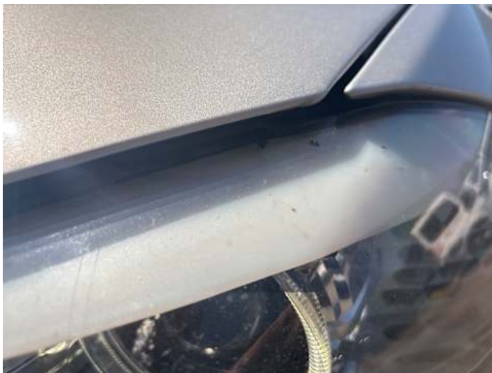
Scheinwerfer (links) (Anderer Schaden): Gummidichtung löst sich
