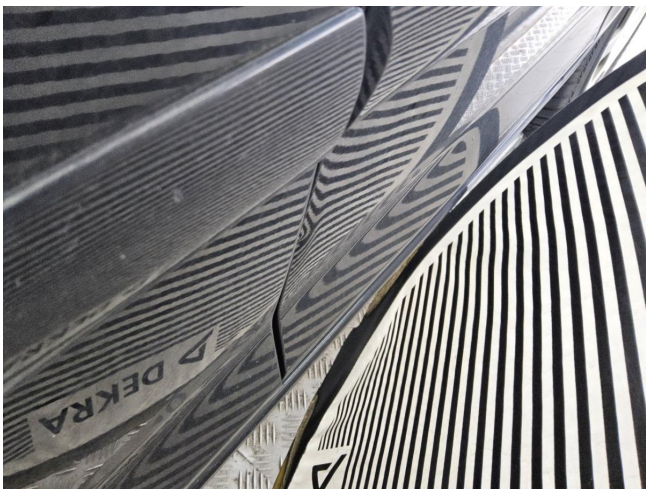
Tür hinten links - Instands. und lackieren
