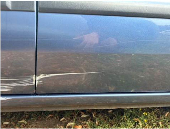
Beifahrertür (Delle, Kratzer, Lackschaden)
