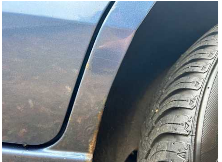
Seitenteil hinten links (Rost)
