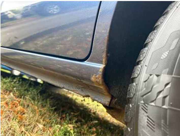
Schweller links (Rost)
