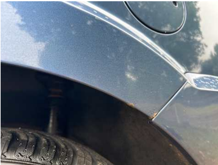
Seitenteil hinten links (Rost)
