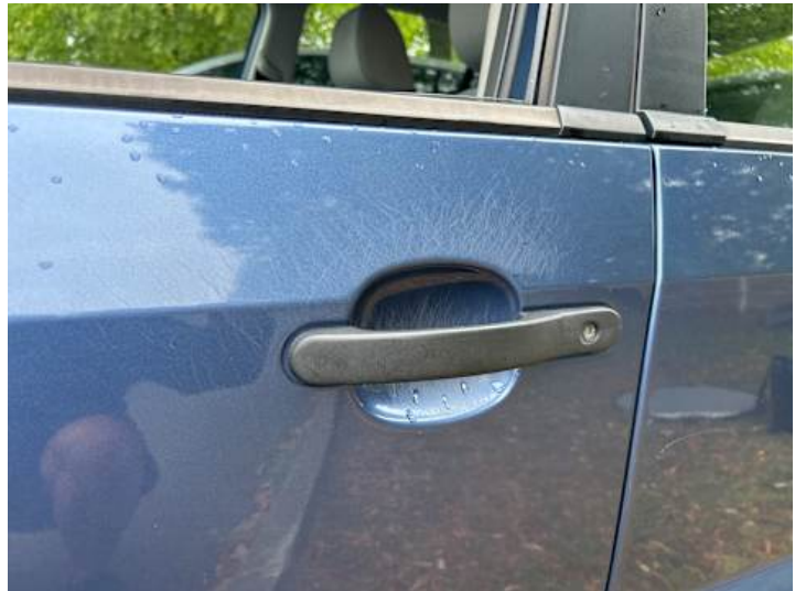
Fahrtür (Kratzer, Lackschaden)
