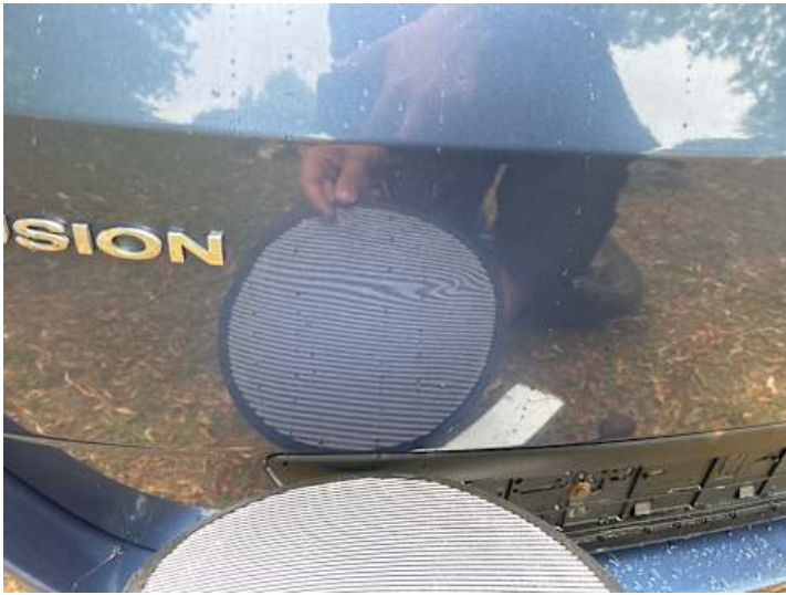
Heckklappe (Lackschaden, Delle)
