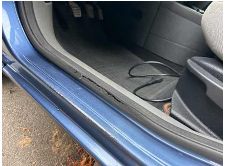
Fahrtür (Kratzer, Lackschaden)
