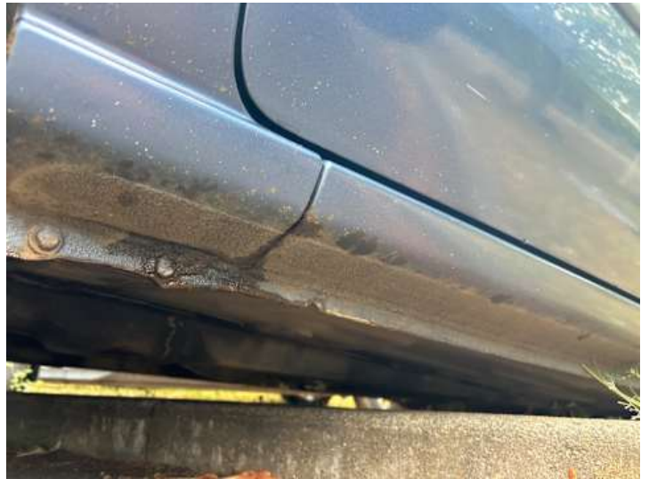
Schweller links (Rost)
