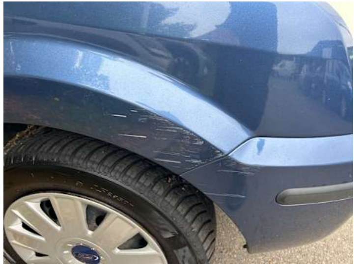
Kotflügel vorne rechts (Kratzer, Lackschaden)
