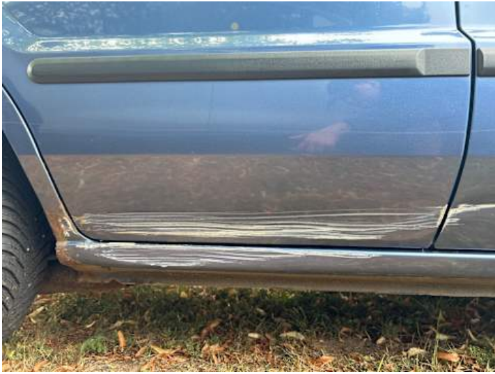
Türe hinten rechts (Delle, Kratzer, Lackschaden, Rost)
