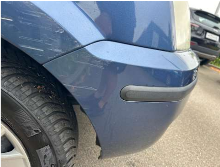
Stoßstange vorne (Kratzer, Lackschaden)
