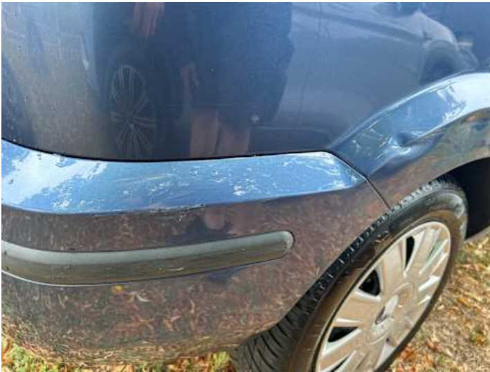
Stoßstange hinten (Kratzer, Lackschaden)
