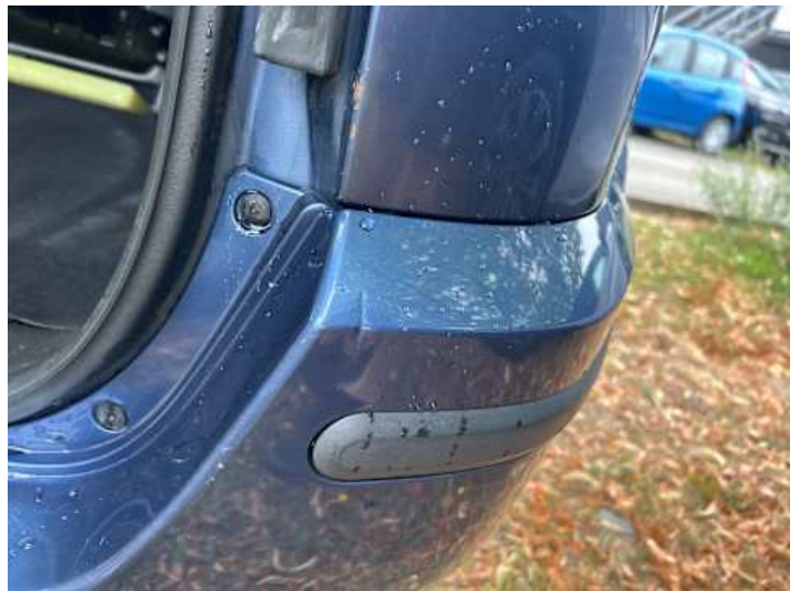
Stoßstange hinten (Kratzer, Lackschaden)
