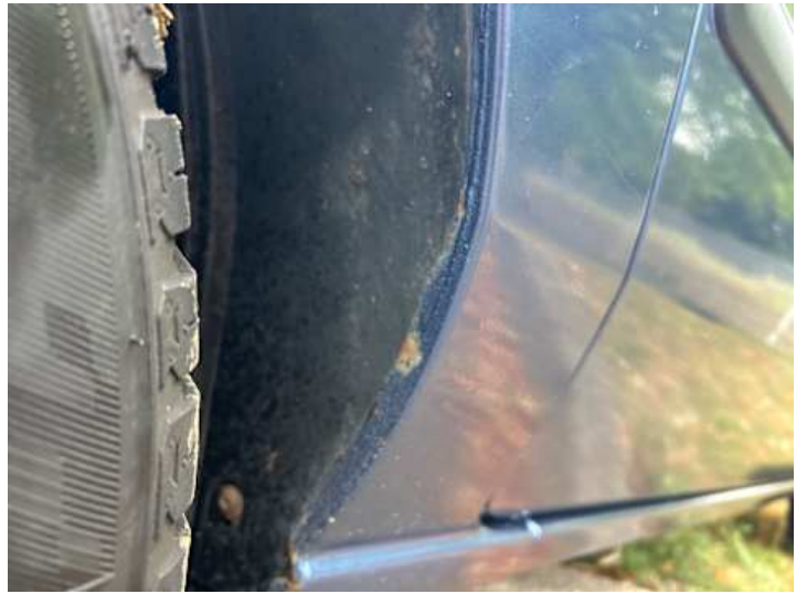
Kotflügel vorne links (Rost)
