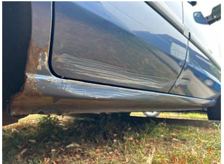
Schweller rechts (Rost, Delle, Lackschaden)
