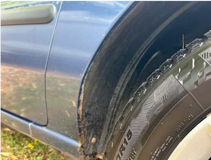
Kotflügel vorne rechts (Rost)
