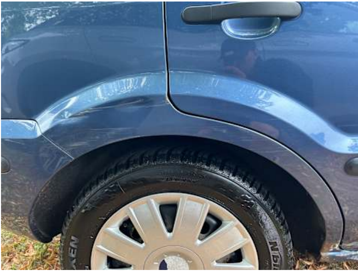
Seitenteil hinten rechts (Rost, Lackschaden, Delle)
