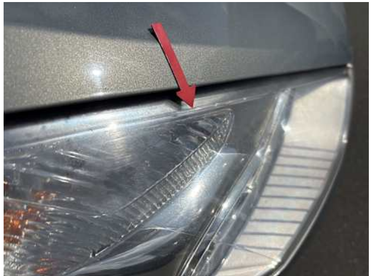
Scheinwerfer (rechts) (Anderer Schaden): Klarlack löst sich
