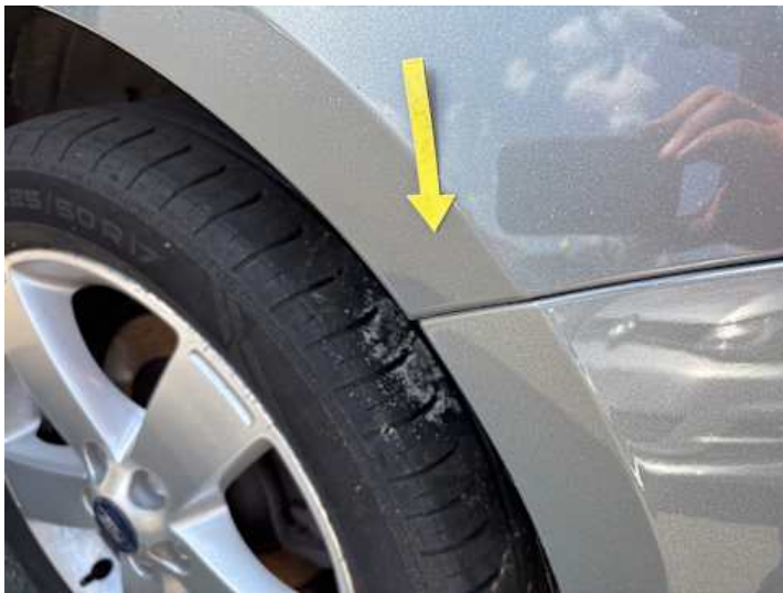
Seitenteil hinten links (Spaltmaße ungenau)
