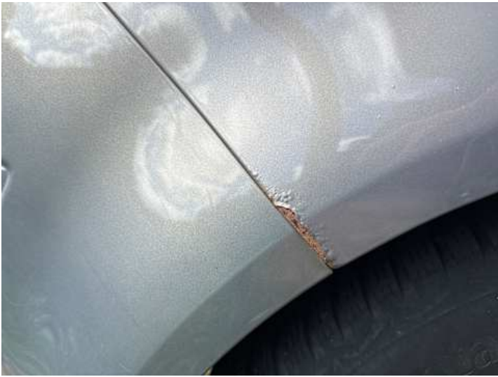
Seitenteil hinten rechts (Kratzer, Rost)
