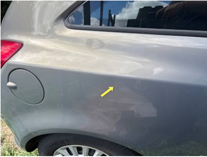
Seitenteil hinten rechts (Kratzer, Rost)
