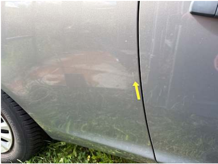
Seitenteil hinten rechts (Kratzer, Rost)
