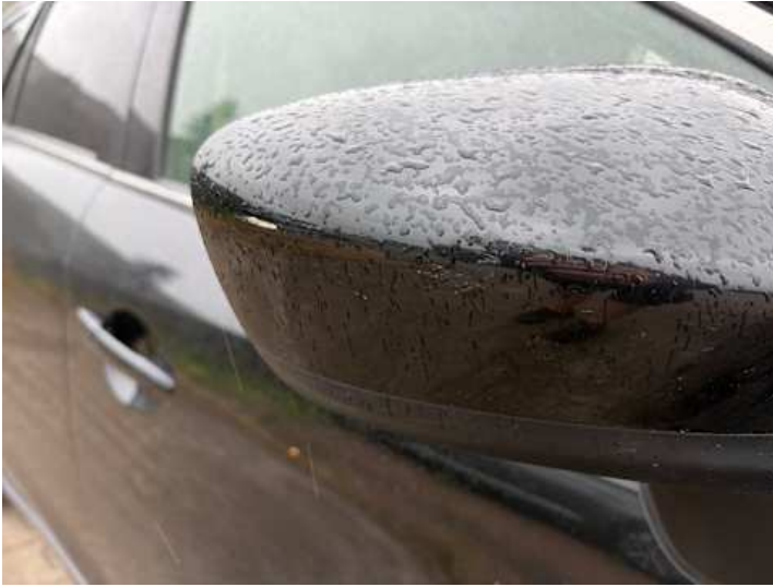
Beifahrertür (Lackschaden, Kratzer)
