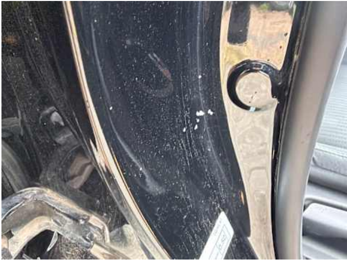
Schweller rechts (Lackschaden)
