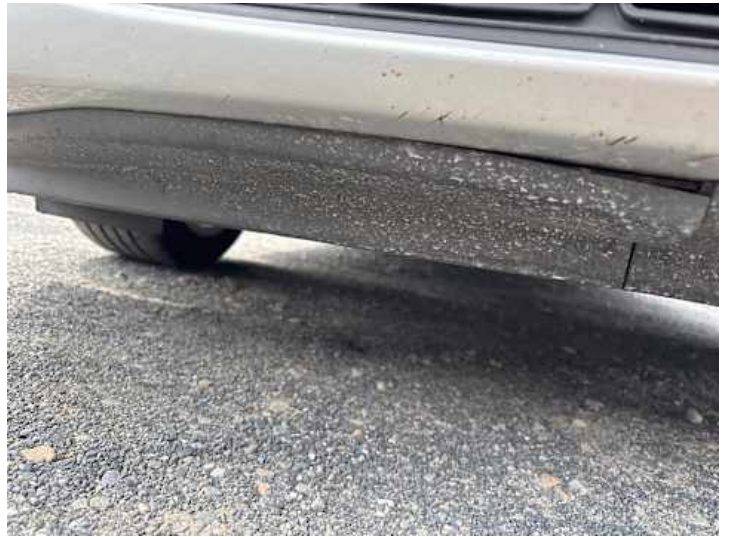
Stoßstange vorne (Lackschaden)
