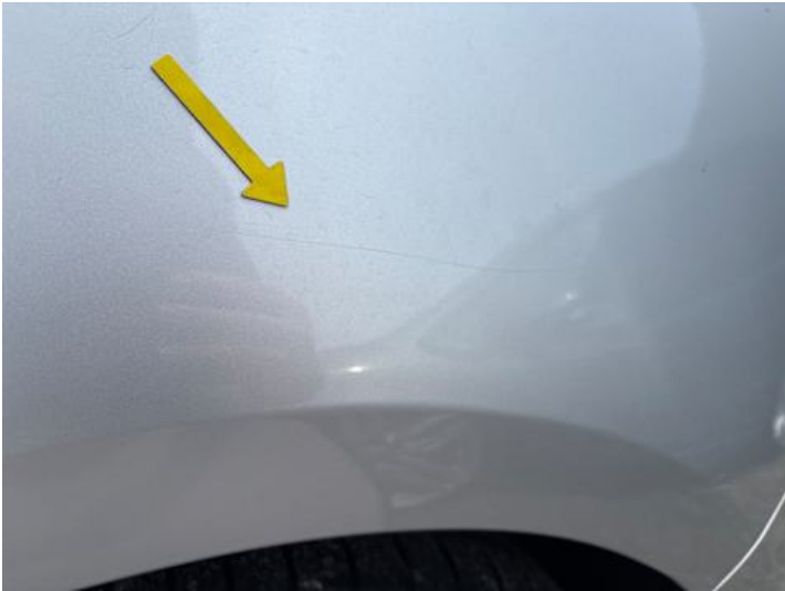
Seitenteil hinten links (Kratzer)
