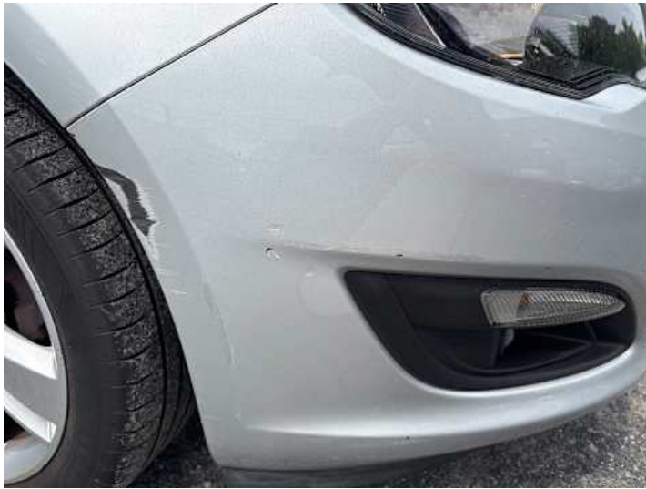
Stoßstange vorne (Lackschaden)
