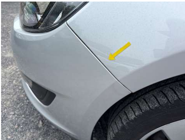
Stoßstange vorne (Spaltmaße ungenau, Unsachgemäß instand gesetzt)
