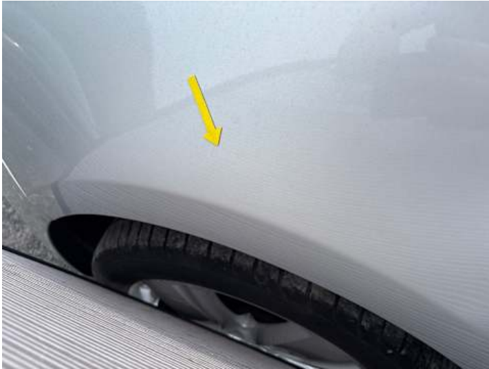
Kotflügel vorne links (Delle)
