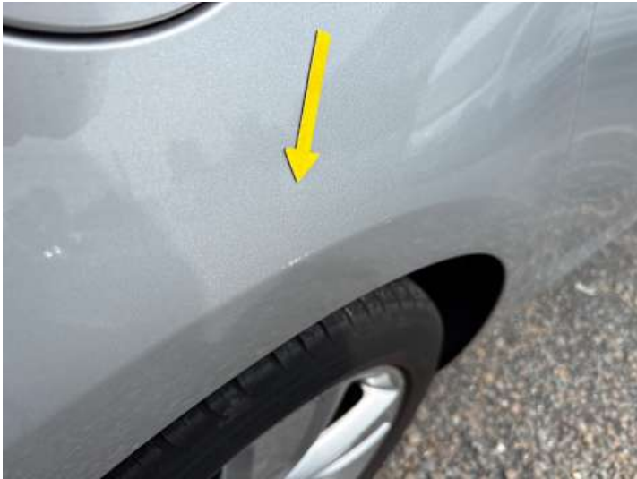
Seitenteil hinten rechts (Lackschaden)
