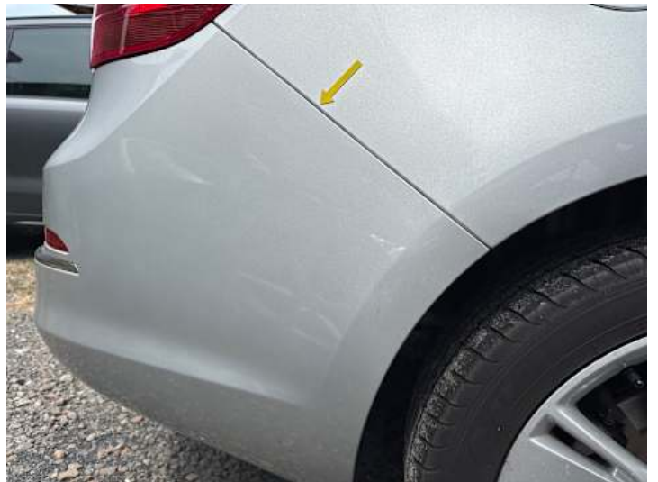
Stoßstange hinten (Unsachgemäß instand gesetzt)
