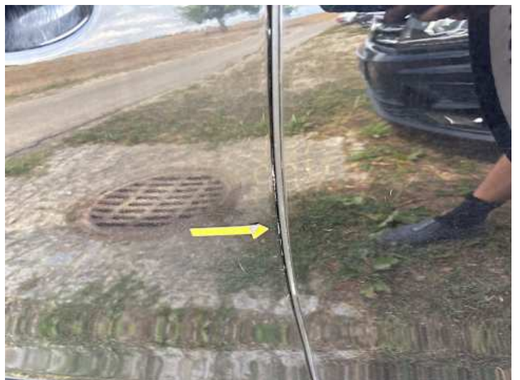
Fahrtür (Delle, Kratzer, Ausgeblichen/Matt)
