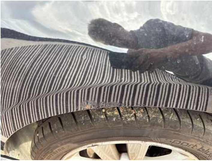
Kotflügel vorne rechts (Rost, Kratzer)
