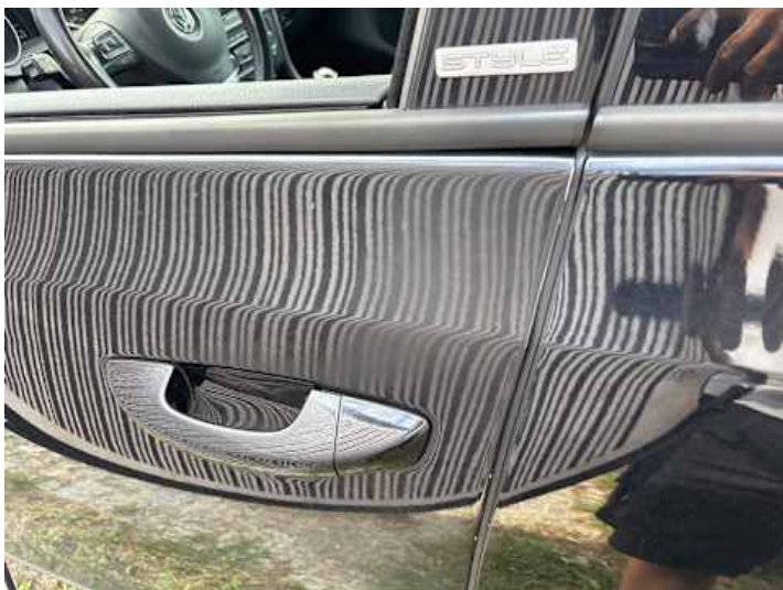
Fahrtür (Delle, Kratzer, Ausgeblichen/Matt)
