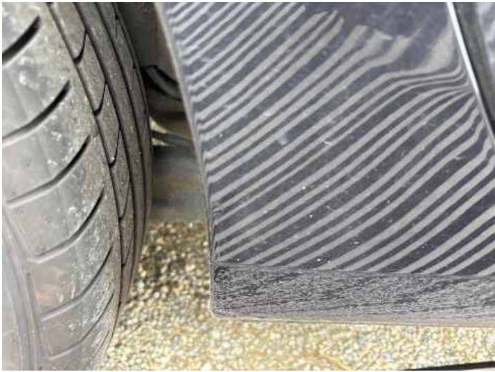
Seitenteil hinten rechts (Delle, Kratzer, Rost)
