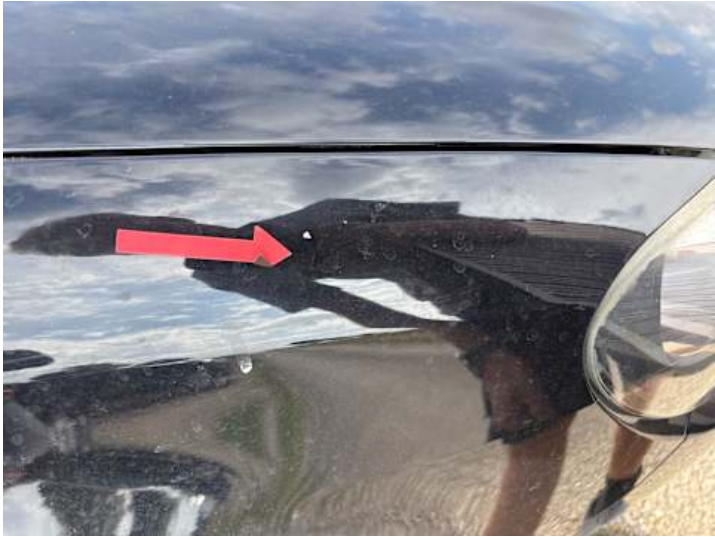
Kotflügel vorne rechts (Rost, Kratzer)
