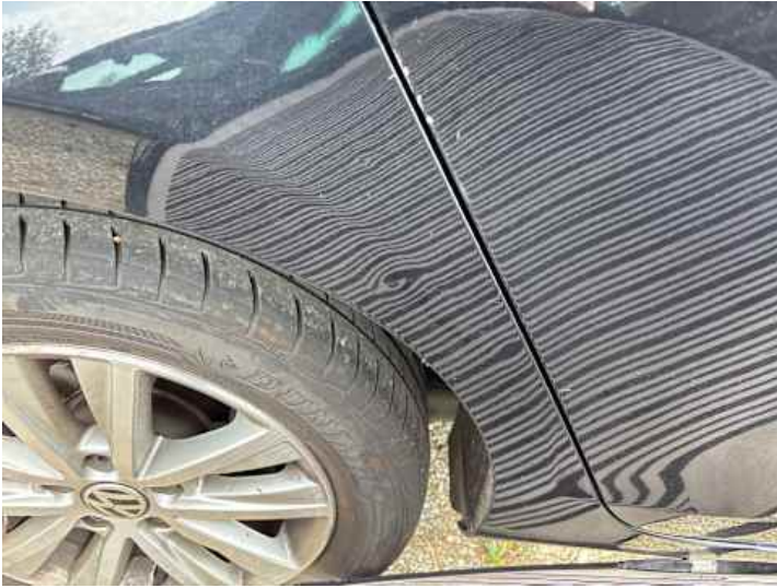
Seitenteil hinten rechts (Delle, Kratzer, Rost)
