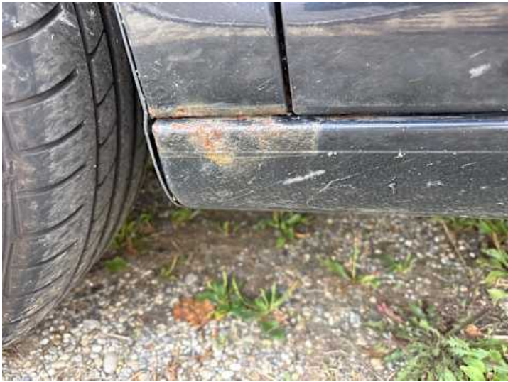
Schweller links (Rost)
