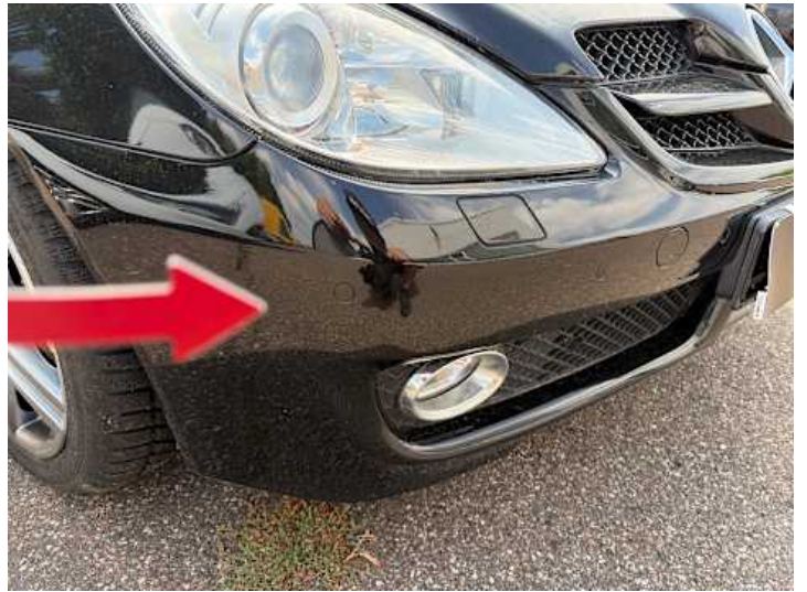
Stoßstange vorne (Kratzer, Steinschlag)
