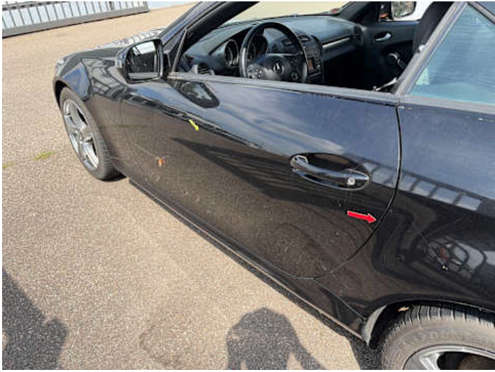
Fahrtür (Kratzer, Delle)
