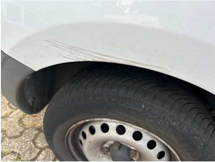
Seitenteil hinten rechts (Kratzer, Verformung)
