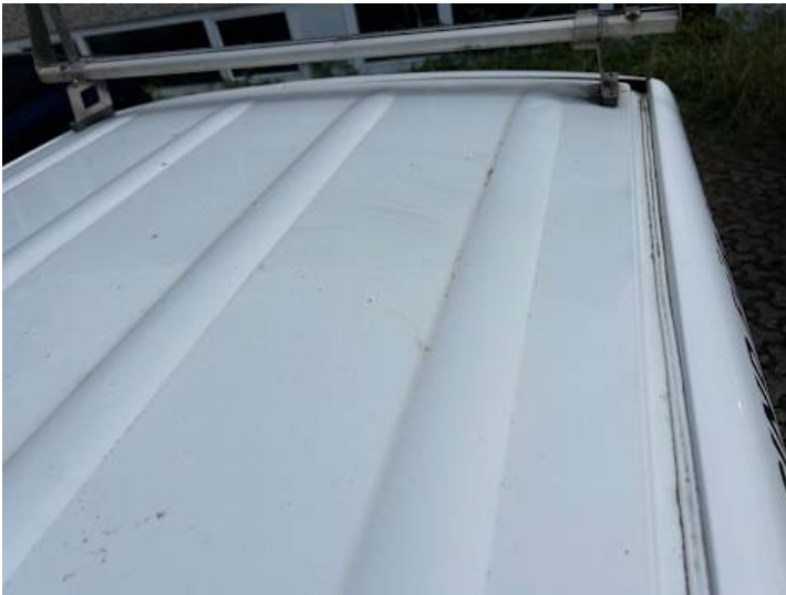
Dach (Kratzer, Verformung)
