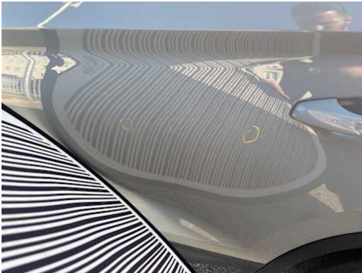
Türe hinten links (Lackschaden, Delle)
