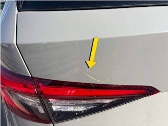
Heckklappe (Lackschaden, Kratzer, Rost)
