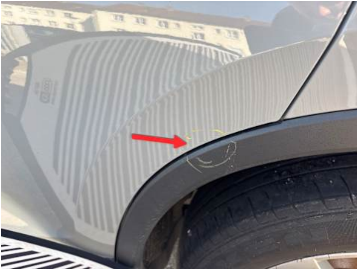
Türe hinten links (Lackschaden, Delle)
