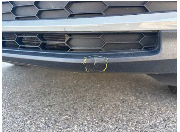
Stoßstange vorne (Kratzer, Lackschaden)
