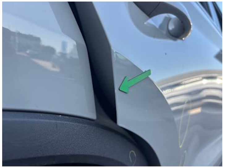
Türe hinten rechts (Kratzer, Lackschaden)
