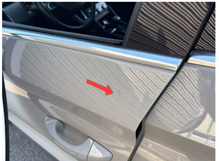
Fahrtür (Kratzer, Delle)
