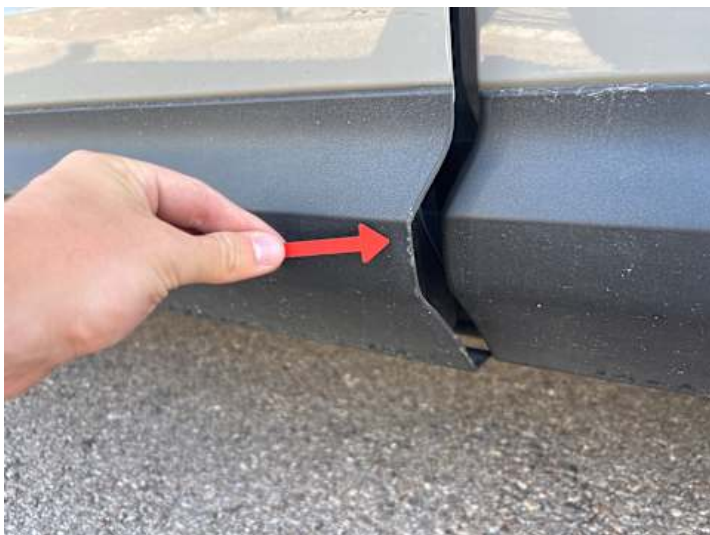
Fahrtür (Kratzer, Delle)
