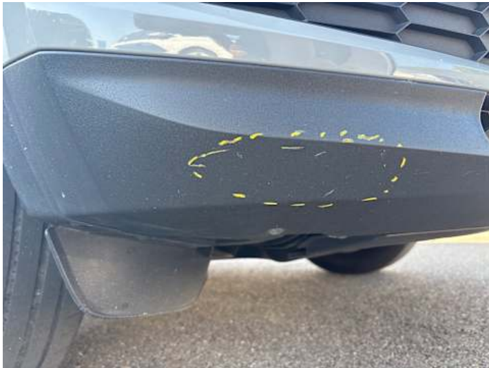
Stoßstange vorne (Kratzer, Lackschaden)
