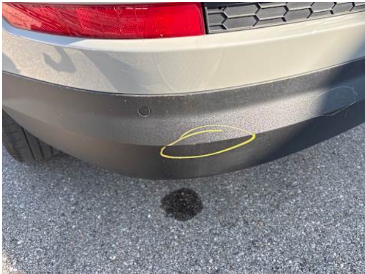
Stoßstange hinten (Kratzer, Lackschaden)
