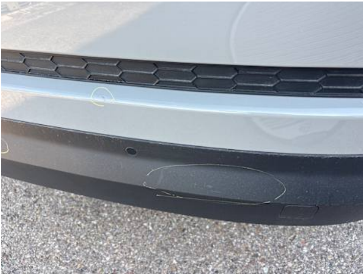
Stoßstange hinten (Kratzer, Lackschaden)
