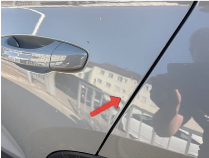
Türe hinten links (Lackschaden, Delle)
