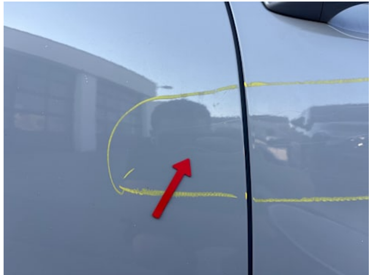
Türe hinten rechts (Kratzer, Lackschaden)
