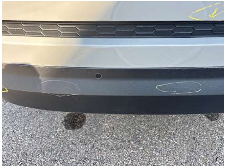
Stoßstange hinten (Kratzer, Lackschaden)
