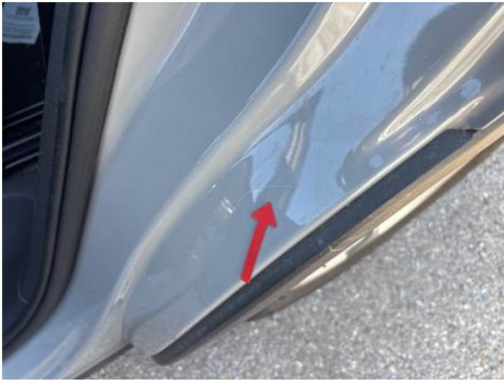
Seitenteil hinten links (Kratzer)
