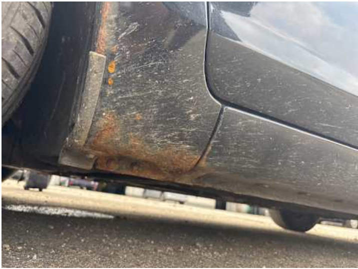
Schweller links (Rost)
