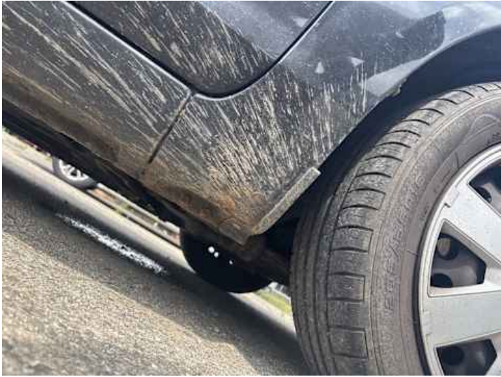
Kotflügel vorne rechts (Rost)
