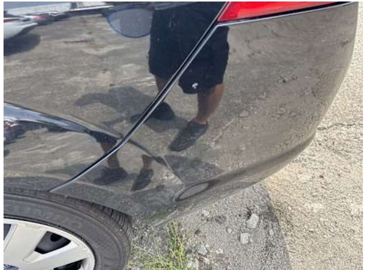
Stoßstange hinten (Spaltmaße ungenau, Kratzer)
