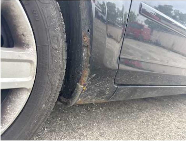
Kotflügel vorne links (Rost)
