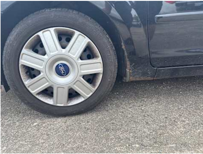
Schweller links (Rost)
