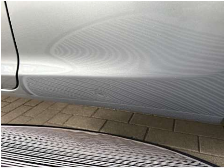
Schweller links (Delle, Steinschlag, Kratzer)
