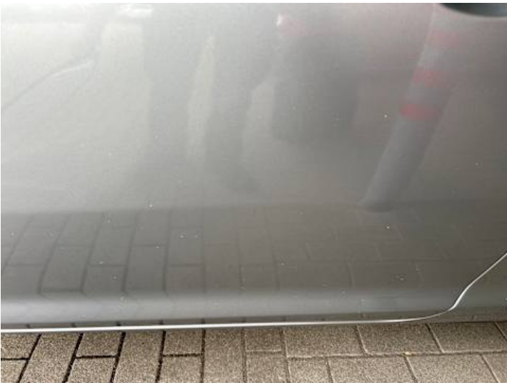
Schweller links (Delle, Steinschlag, Kratzer)
