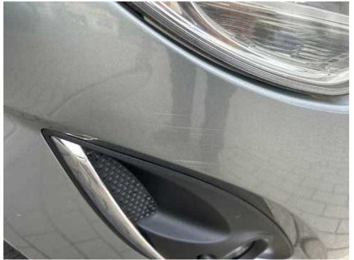
Stoßstange vorne (Kratzer, Spaltmaße ungenau)
