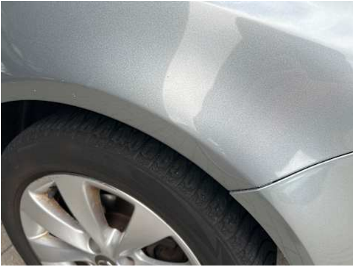
Kotflügel vorne rechts (Steinschlag)
