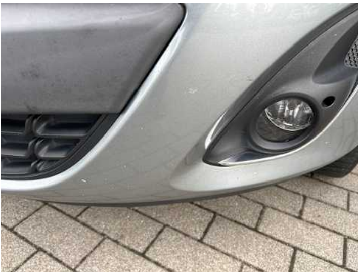
Stoßstange vorne (Kratzer, Spaltmaße ungenau)
