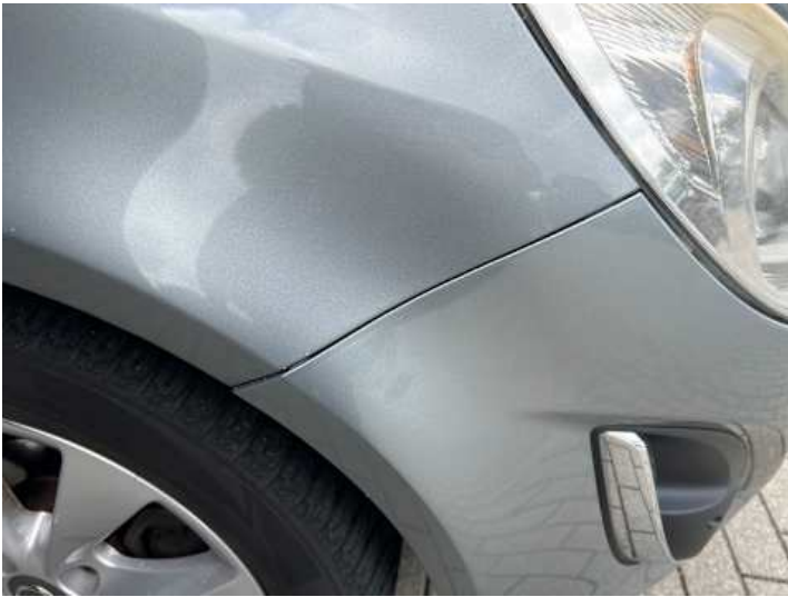
Stoßstange vorne (Kratzer, Spaltmaße ungenau)
