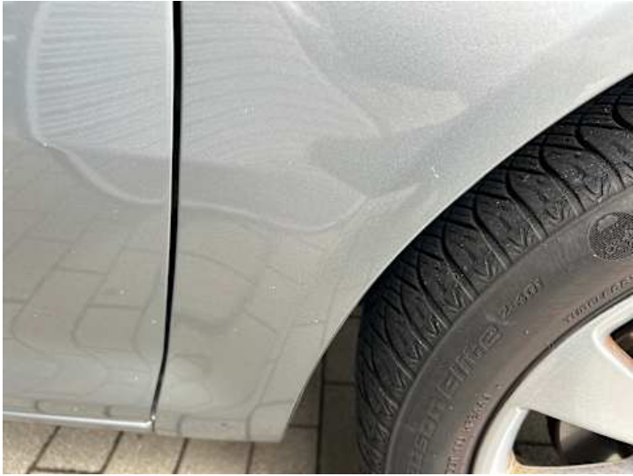
Kotflügel vorne rechts (Steinschlag)
