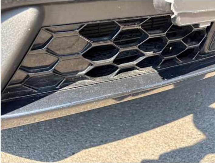
Stoßstange vorne (Steinschlag)
