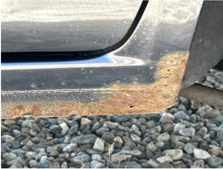
Schweller links (Rost)
