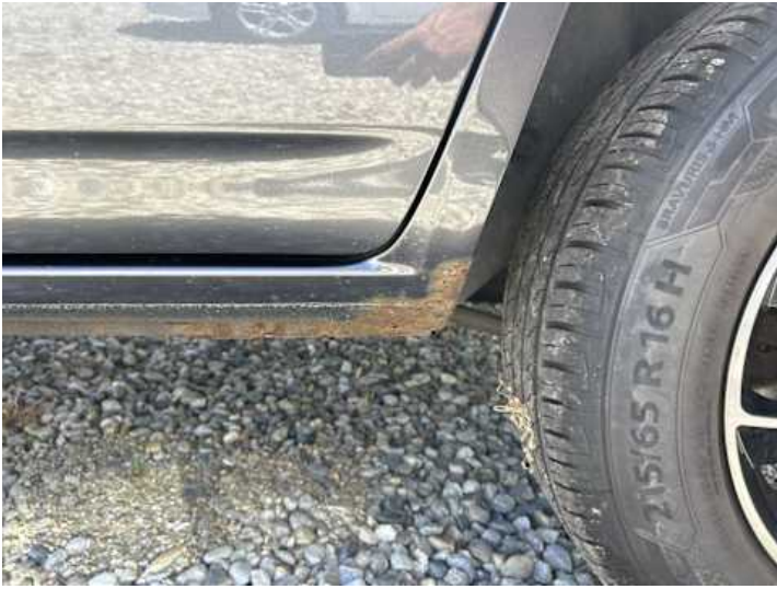
Schweller links (Rost)
