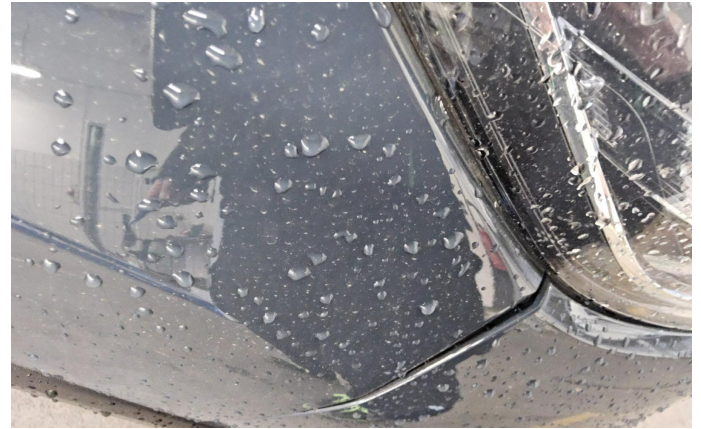
Bild 2: Außen, Kotflügel vorne rechts, Einpassung ungenau, einpassen, Kostenerweiterung möglich
