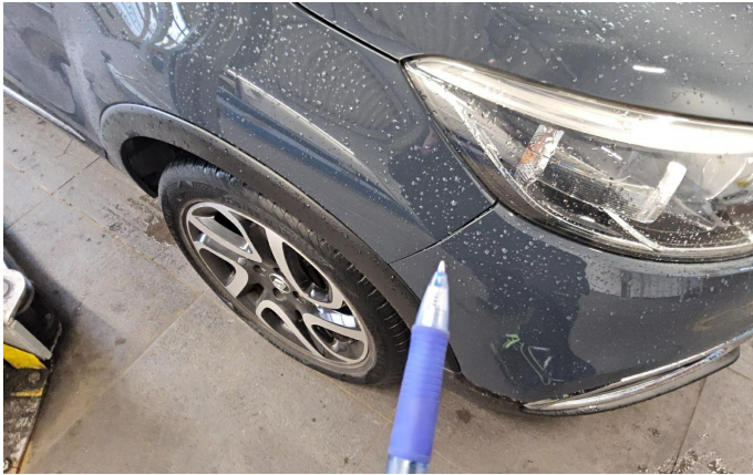
Bild 1: Außen, Kotflügel vorne rechts, Einpassung ungenau, einpassen, Kostenerweiterung möglich
