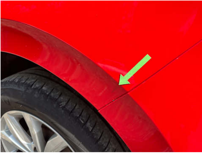
Seitenteil hinten links (Delle, Rost, Lackschaden)
