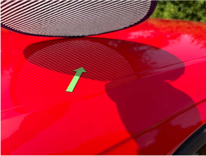
Dach (Delle, Kratzer)
