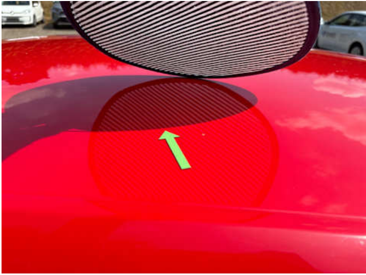
Dach (Delle, Kratzer)
