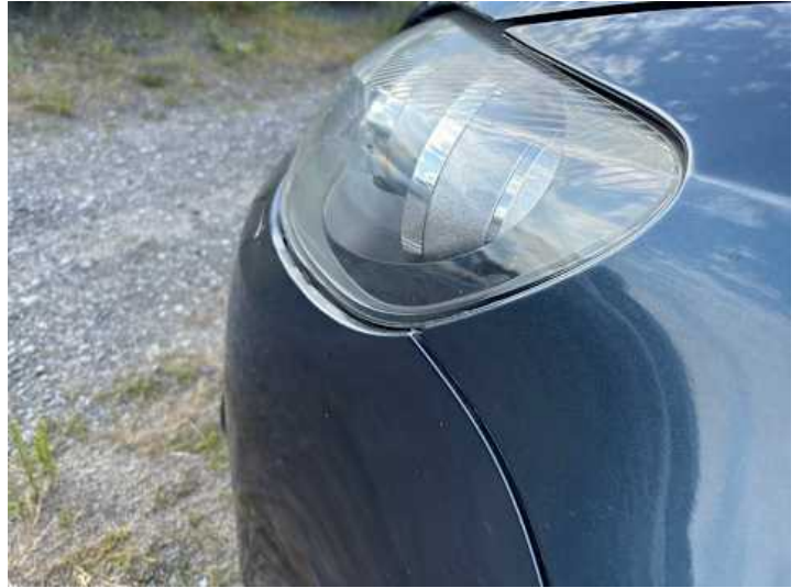
Stoßstange vorne (Spaltmaße ungenau)
