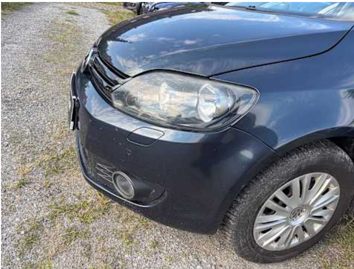
Stoßstange vorne (Spaltmaße ungenau)
