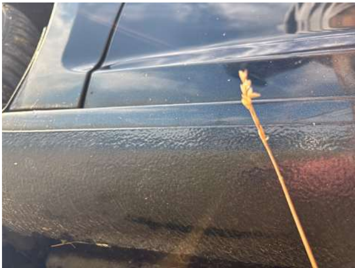
Schweller links (Verformung)
