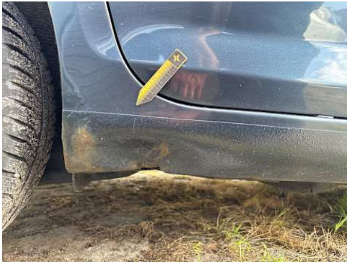
Schweller rechts (Verformung)
