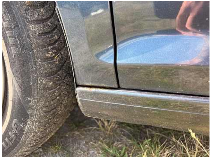
Schweller links (Rost)
