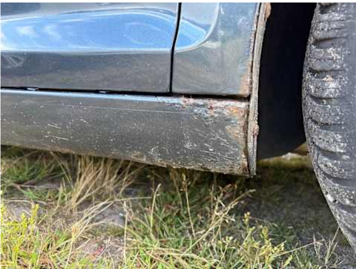
Schweller rechts (Rost)
