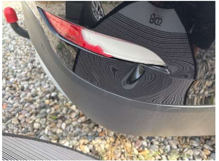
Stoßstange hinten (Riss/Bruch, Verformung)
