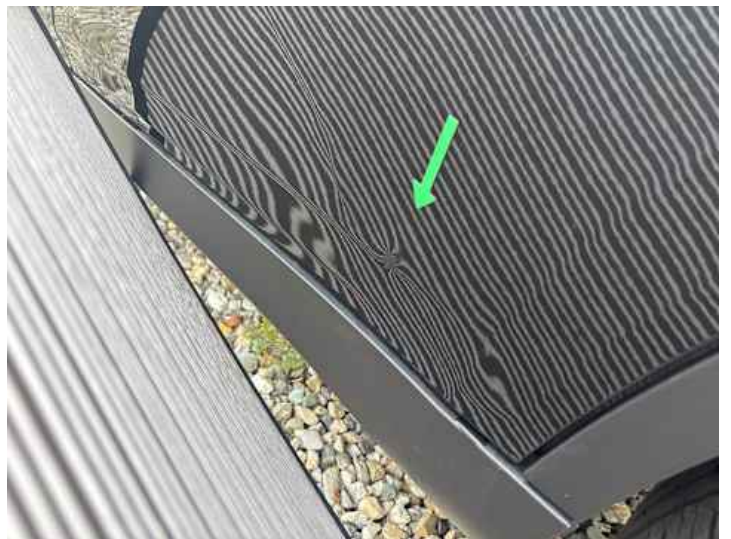
Türe hinten links (Verformung)
