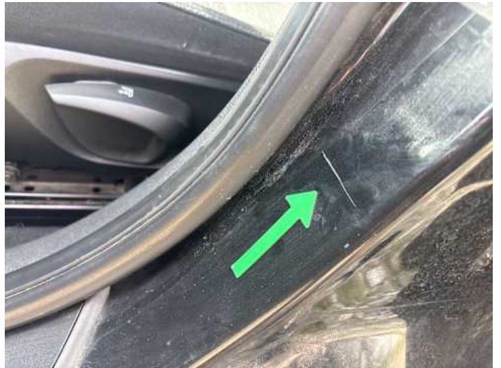
Schweller links (Kratzer)
