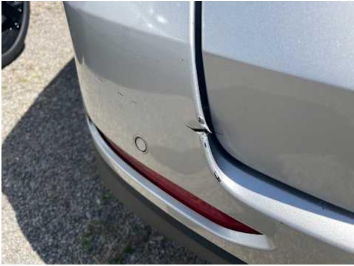
Stoßstange hinten (Lackschaden, Riss/Bruch)
