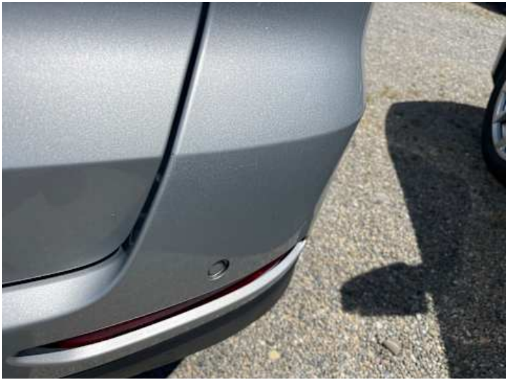
Stoßstange hinten (Lackschaden, Riss/Bruch)
