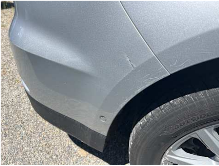
Stoßstange hinten (Lackschaden, Riss/Bruch)
