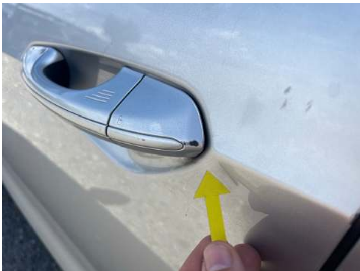
Fahrtür (Lackschaden, Verformung)
