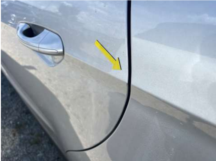
Türe hinten links (Lackschaden)
