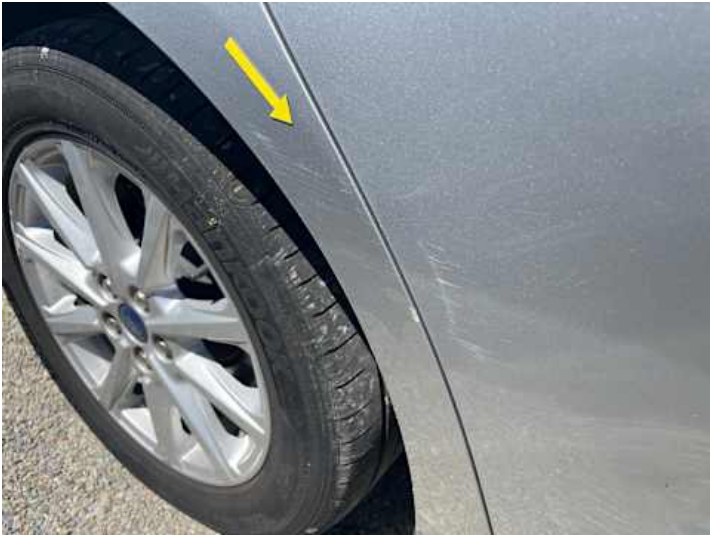
Seitenteil hinten rechts (Lackschaden, Verformung)
