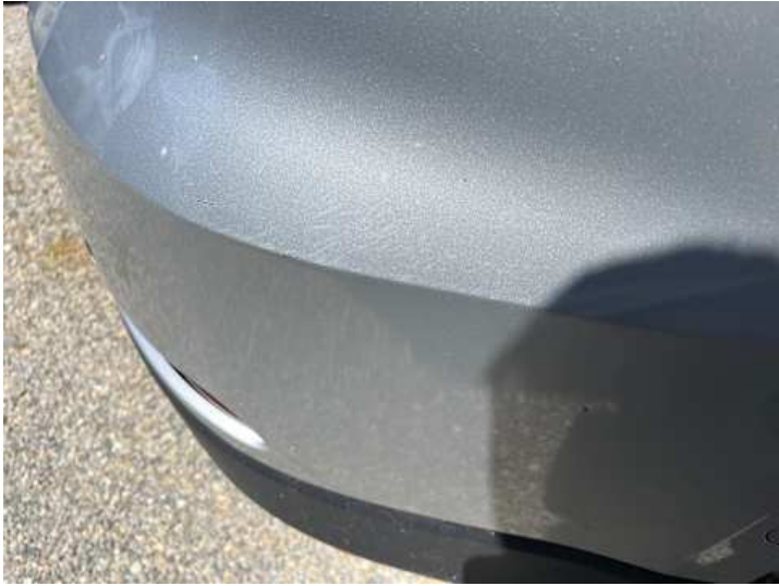
Stoßstange hinten (Lackschaden, Riss/Bruch)
