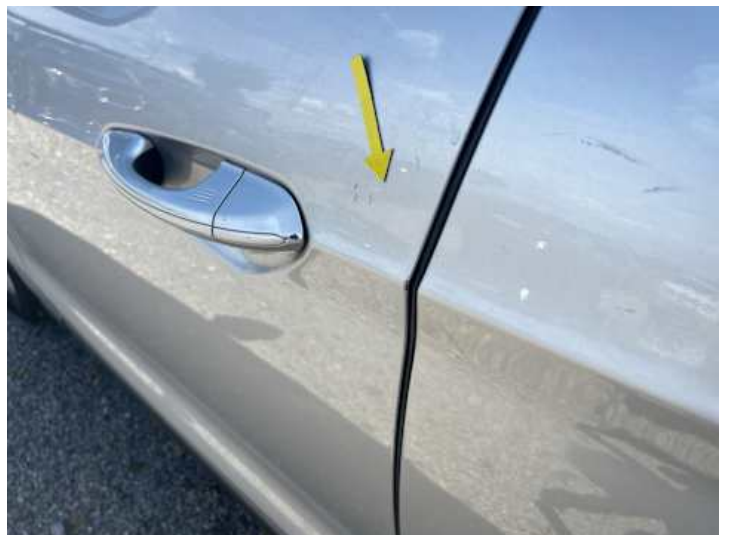
Fahrtür (Lackschaden, Verformung)
