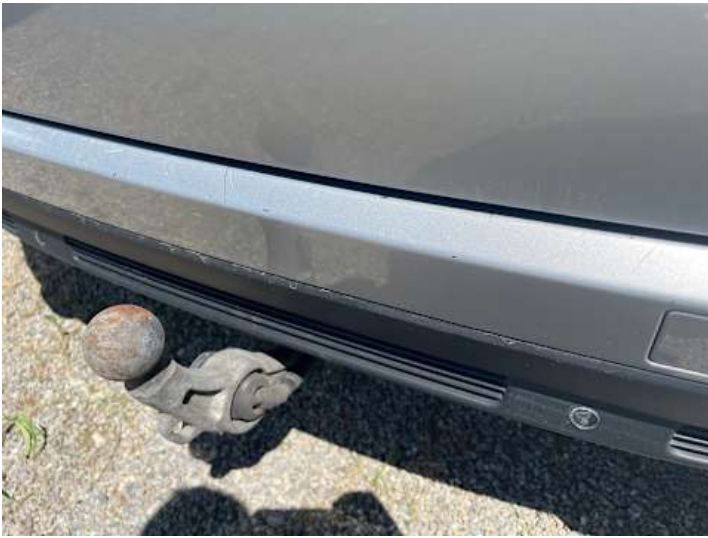
Stoßstange hinten (Lackschaden, Riss/Bruch)
