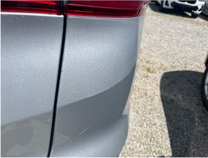
Stoßstange hinten (Lackschaden, Riss/Bruch)
