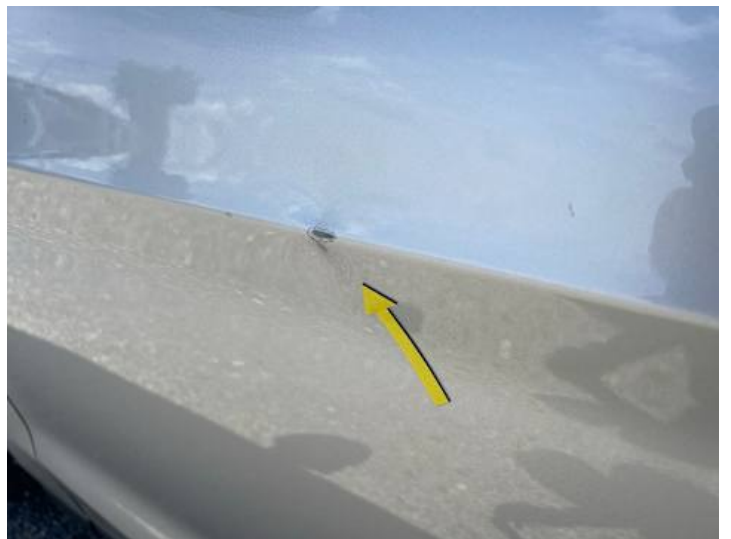
Fahrtür (Lackschaden, Verformung)
