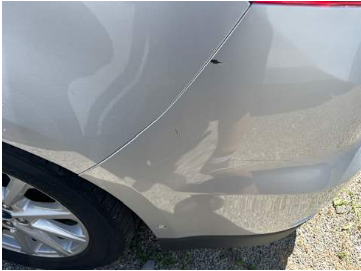
Stoßstange hinten (Lackschaden, Riss/Bruch)
