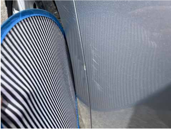
Seitenteil hinten rechts (Lackschaden, Verformung)
