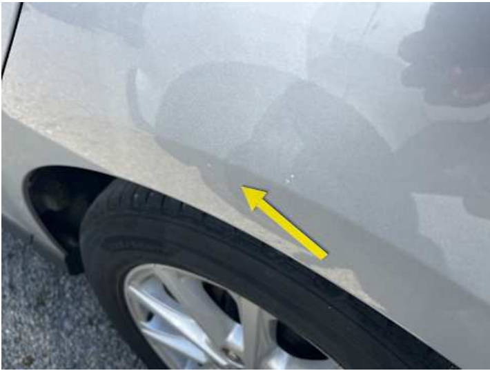
Seitenteil hinten links (Lackschaden)
