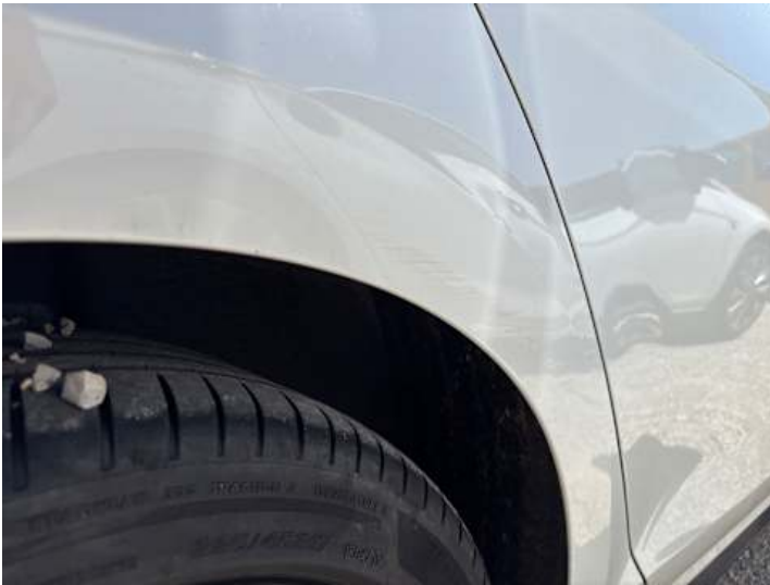
Seitenteil hinten rechts (Lackschaden, Verformung)
