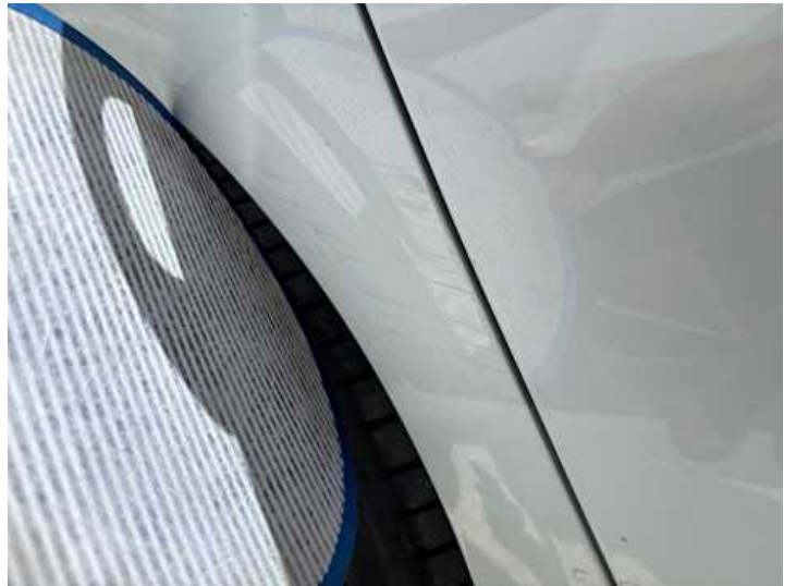
Seitenteil hinten rechts (Lackschaden, Verformung)
