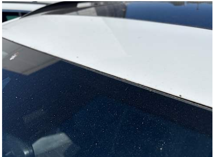
Dach (Lackschaden, Rost)
